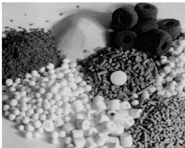
Σχήμα 2. 2: Φωτογραφική απεικόνιση διάφορων μορφών των καταλυτών που εμφανίζονται στη βιομηχανία σε σύγκριση με μία ασπιρίνη [31].
