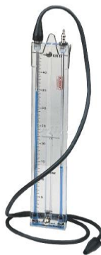
Εικόνα 20 Μανόμετρο στήλης υγρού
