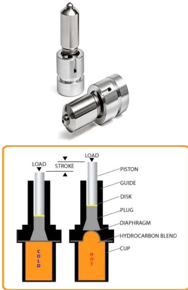
Εικόνα 43 Θερμικοί ενεργοποιητές και το εσωτερικό τους.
