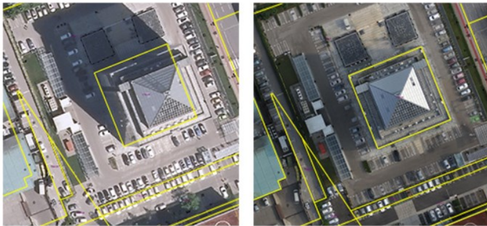
Εικόνα 7 - Σφάλματα μιας κοινής Αεροφωτογραφίας σε σχέση με μια Ορθοφωτογραφία
