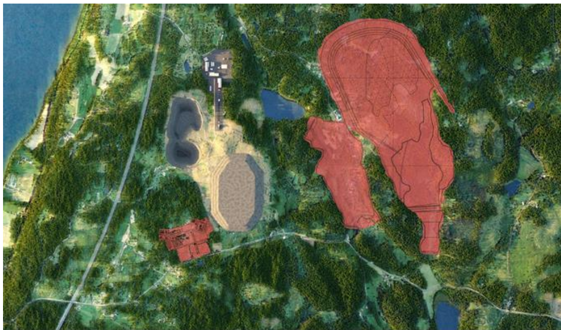
Εικόνα 14: Γραφική απεικόνιση του επιτόπιου ανοιχτού λάκκου του Norra Kärr, της εγκατάστασης απορριμμάτων βράχων και της μονάδας φυσικού εμπλουτισμού σε σύγκριση με την Προκαταρκτική Μελέτη Σκοπιμότητας του 2015 (με κόκκινο χρώμα βλέπουμε το φράγμα απορριμμάτων)(68)
