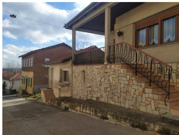
Εικόνα 96. Κτίριο της οδού Ελ. Βενιζέλου, παρατηρείται μίμηση της σκάλας εισόδου επηρεασμένη από το κουκουλόσπιτο του Μπουρουλίτη (αριστερά), ψευδαίσθηση πέτρας και τοποθέτηση δύο συνεχόμενων ανοιγμάτων για περισσότερο φως ξεπερνώντας το επιτρεπτό όριο πλάτους ανοίγματος 1,20 μ.
