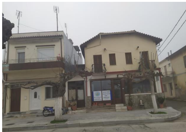
Εικόνα 94. Κτίριο κατοικίας στην οδό Β. Γεωργίου, μεσοτοιχία με το κτίριο της Α. Δερμεντζόγλου. Παρατηρείται εξώστης από μπετόν καθώς και κουφώματα αλουμινίου. Το κτίριο είναι από τα ελάχιστα κτίρια στον οικισμό με δώμα, δεν υπακούει στην νομοθεσία καθώς η σκεπή επιβάλλεται.
