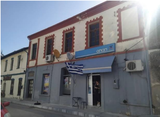
Εικόνα 66. Παράδειγμα κτιρίου με προσθήκη ταμπέλας, κεραίες και κλιματιστικά καθώς και αλλαγή των κουφωμάτων του ισόγειου που λειτουργεί ως κατάστημα.
