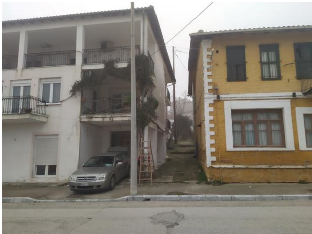
Εικόνα 89. Κτίριο στην Β. Γεωργίου, συνορεύει με δημόσιο παραδοσιακό κτίριο. Παρατηρείται μίμηση του εξώστη στον πρώτο όροφο κατασκευασμένος όμως με σύγχρονα υλικά. Οι εσωτερικοί εξώστες των ορόφων δημιουργούν δυσαρμονία σε ότι αφορά την συνολική εικόνα του κτιρίου και την συνέχεια της όψης.
