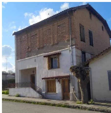
Εικόνα 73. Κτίριο στην οδό Ανδριανουπόλεως, παρατηρούμε αλλαγές στα ανοίγματα στο ισόγειο το οποίο λειτουργεί ως κατοικία. Επίσης έχουν κλείσει τα ανοίγματα του ορόφου ο οποίος όπως φαίνεται δεν χρησιμοποιείται.
