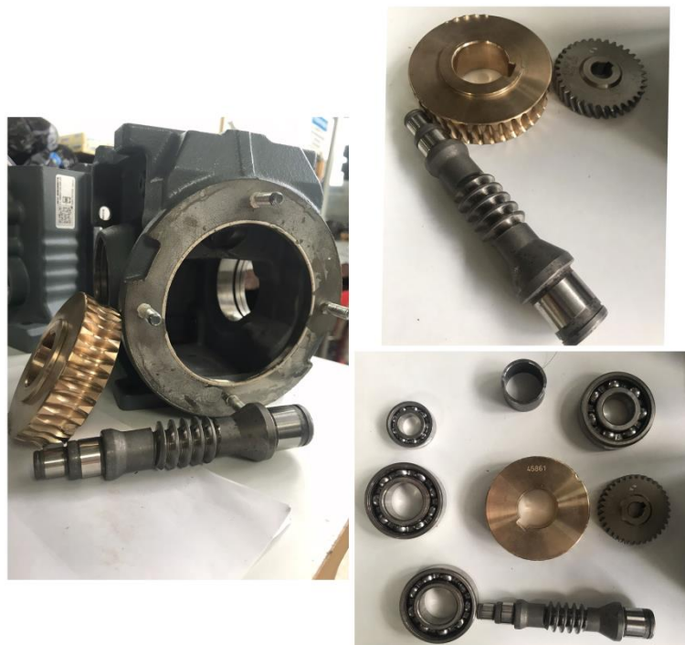
Σχήμα 48: Αποσυναρμολογημένα τμήματα μειωτήρα.
