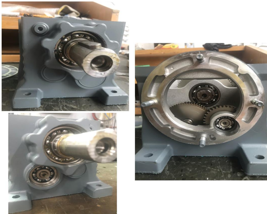
Σχήμα 30: Αρχικό στάδιο αποσυναρμολόγησης
