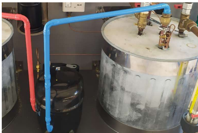
Εικόνα 3.26: Χρωματισμός γραμμής αναρρόφησης
