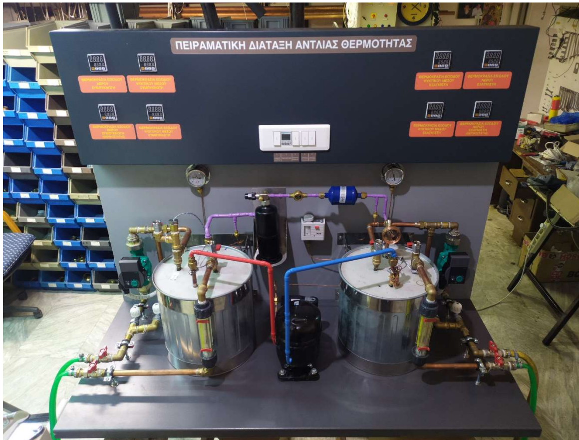
Εικόνα 3.1: Πειραματική διάταξη αντλίας θερμότητας νερού - νερού
