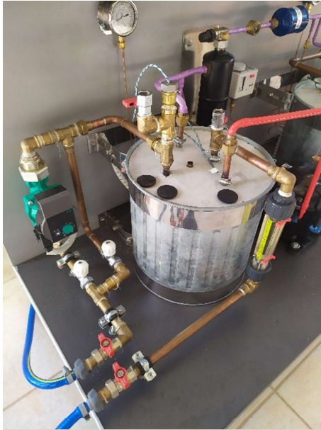
Εικόνα 3.36: Υδραυλικό κύκλωμα δοχείου συμπυκνωτή (αριστερά) και υδραυλικό κύκλωμα δοχείου εξατμιστή (δεξιά)
