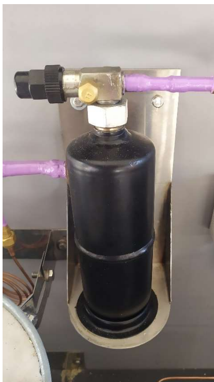
Εικόνα 3.14: Σύνδεση συλλέκτη υγρού ψυκτικού μέσου στο ψυκτικό κύκλωμα
