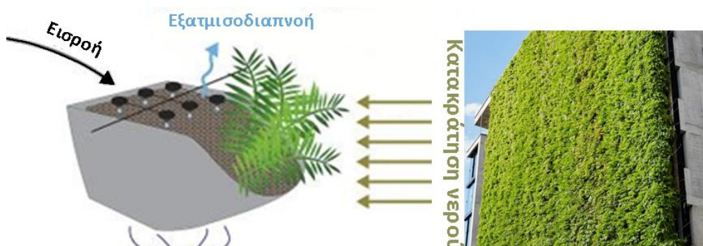
Εικόνα 17: Πως λειτουργεί η εξατμισοδιαπνοή στον πράσινο τοίχο
