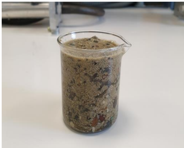
Εικόνα 6.1.4 1L δείγματος έπειτα από φυγοκέντριση και περισυλλογή των επιπλεόντων (ΕΕΛ Ηρακλείου).
