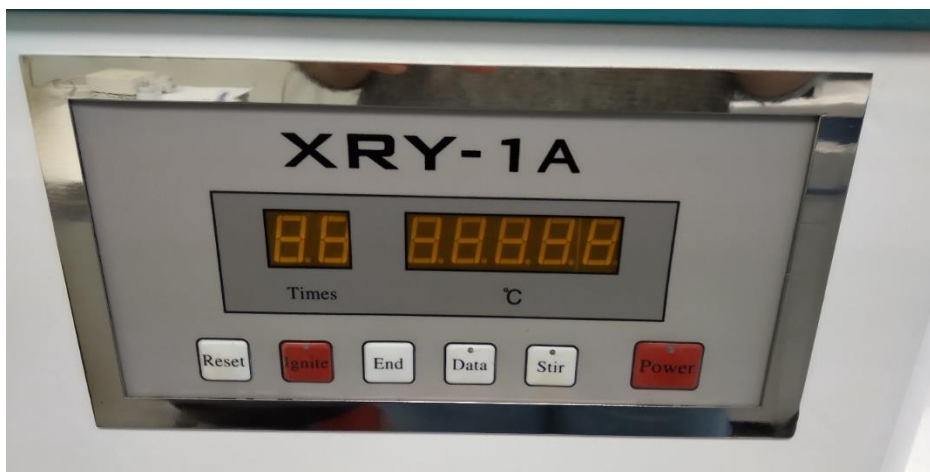
Εικόνα 5.4.5 Πίνακας ελέγχου θερμιδόμετρου (Ενδείξεις Stir και Reset).
