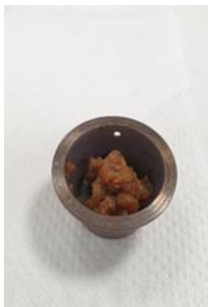
Εικόνα 5.4.2 Κεφαλή βόμβας οξυγόνου, τοποθετημένο σύρμα ανάφλεξης στους δύο πόλους και 1g δείγματος στο χωνευτήριο.
