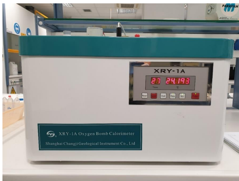
Εικόνα 5.4.1 Θερμιδόμετρο βόμβας οξυγόνου (XRY-1A Oxygen Bomb Calorimeter).
