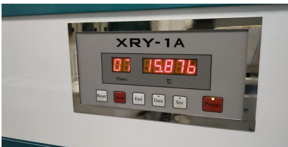
Εικόνα 5.4.6 Ένδειξη Ignite και 7 η από τις 31 συνολικά αναγραφόμενες τιμές.
