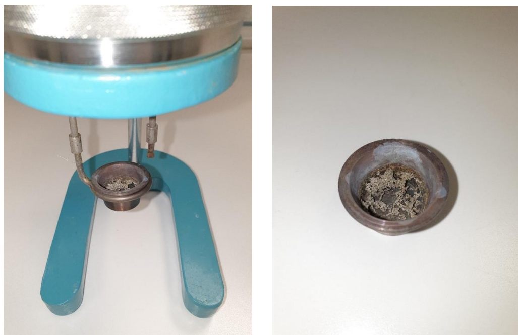
Εικόνα 5.4.7 Δείγμα λιπών και ελαίων μετά την ολοκλήρωση της θερμιδομέτρησης [Εργαστήριο Σχεδιασμού Περιβαλλοντικών Διεργασιών Πολυτεχνείου Κρήτης, 2021].
