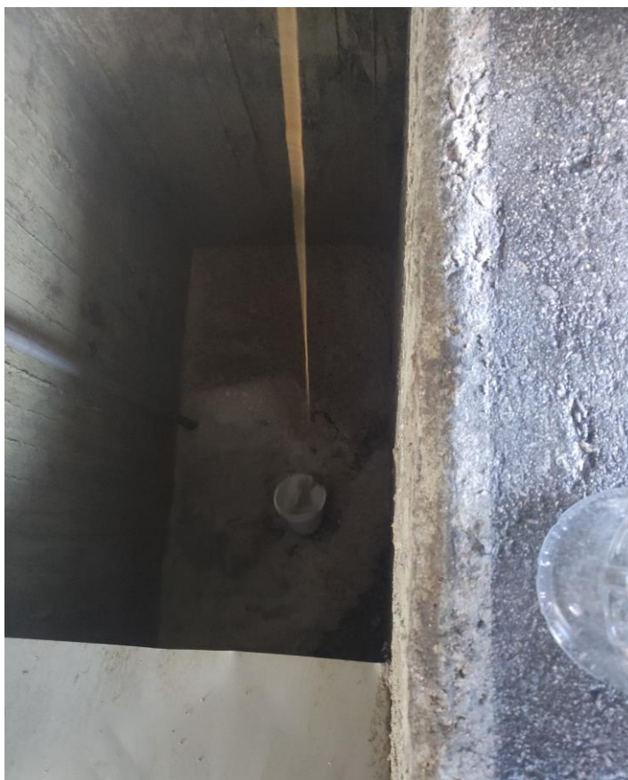
Εικόνα 5.2.1 Δειγματοληψία μέσα από φρεάτιο συλλογής λιπών [ΕΕΛ Ρεθύμνου, 2021].
