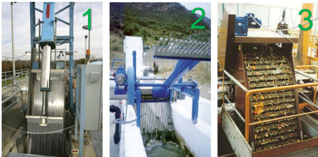
Εικόνα 2.1.1 Τυπική διάταξη αυτοκαθαριζόμενων εσχάρων (1. Επίπεδη, 2. Καμπύλη, 3. Κυλιόμενου ιμάντα) [Γκίκας, 2020].
