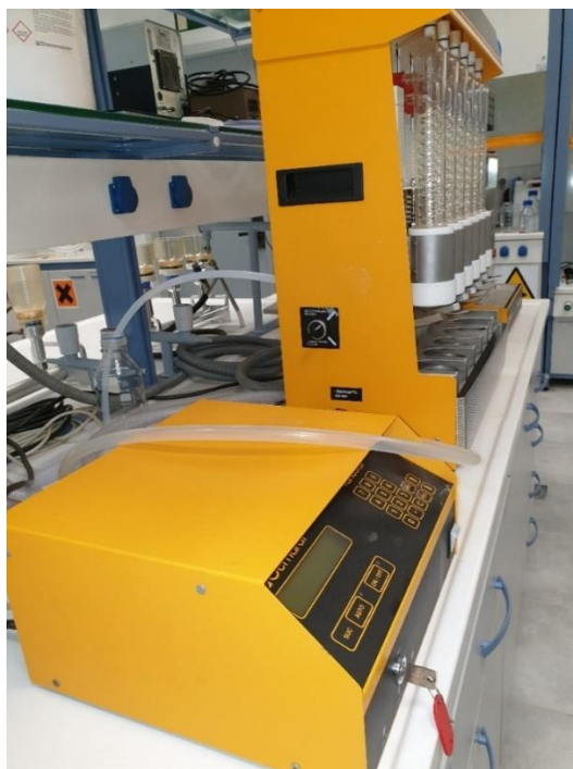
Εικόνα 5.3.1 Διάταξη συστήματος Soxtherm – Μονάδας ελέγχου (Variostat).
