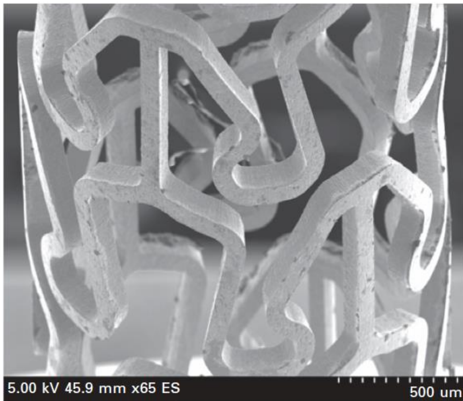
Σχήμα 20: Ένα stent από ανοξείδωτο χάλυβα κομμένο με λέιζερ ινών single mode, από το Πανεπιστήμιο του Μάντσεστερ [18]
