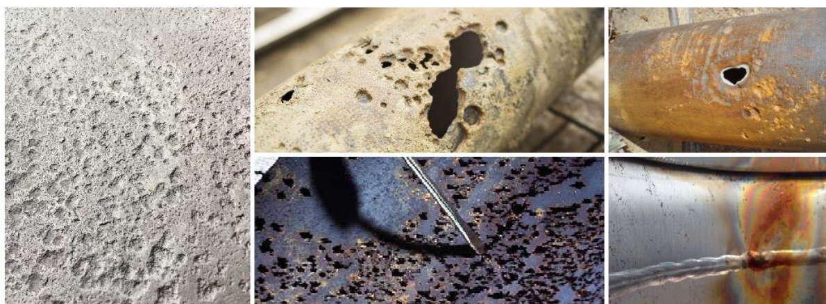
Εικόνα 4.5 Παραδείγματα διαβρώσεων (pitting corrosion)
