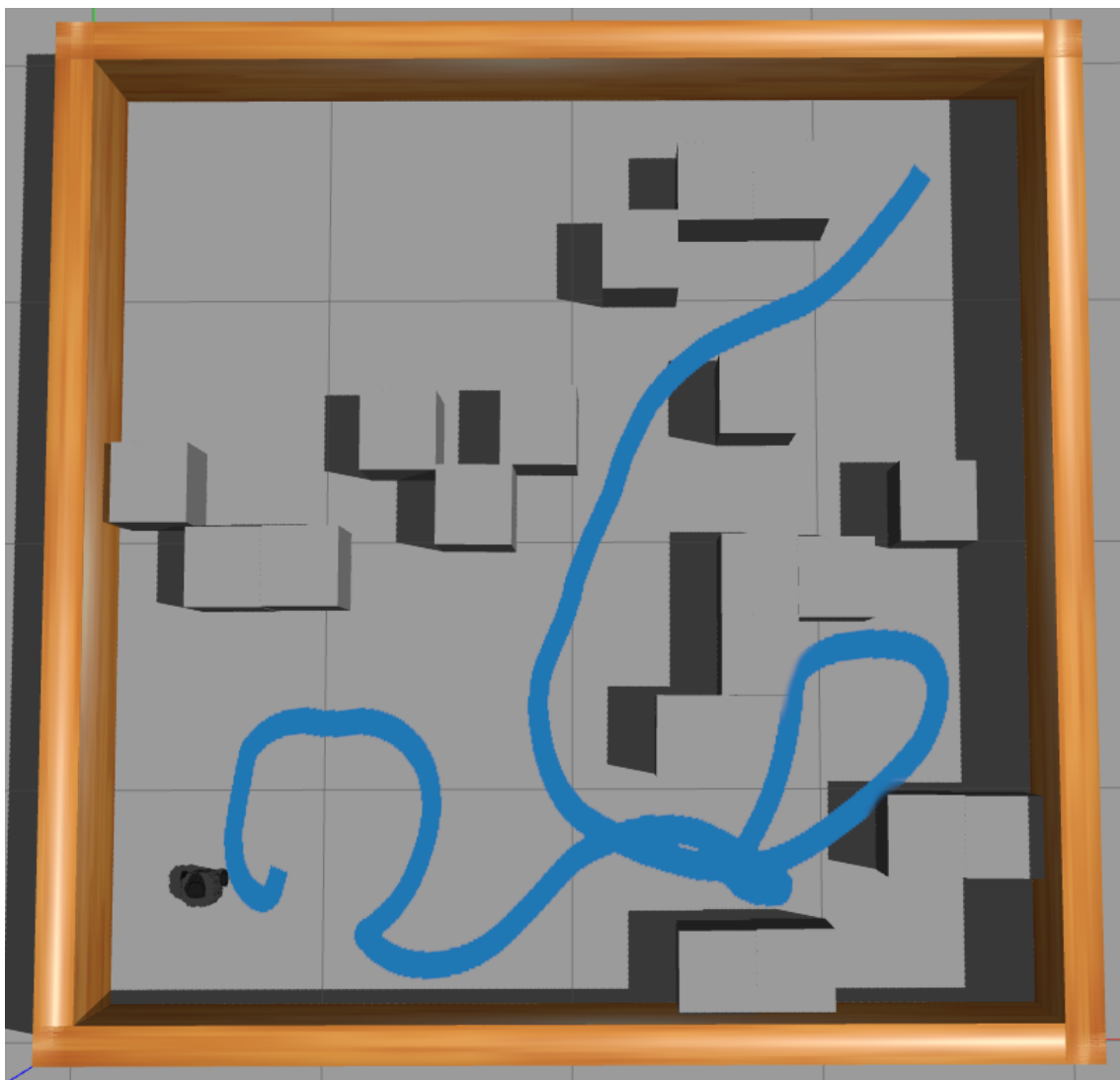
Σχήμα 5.44: Η τροχιά που ακολούθησε το ρομποτικό όχημα στο δεύτερο άγνωστο περιβάλλον, σύμφωνα με τους κόμβους που του υπαγόρευε ο αλγόριθμος CIA*.
