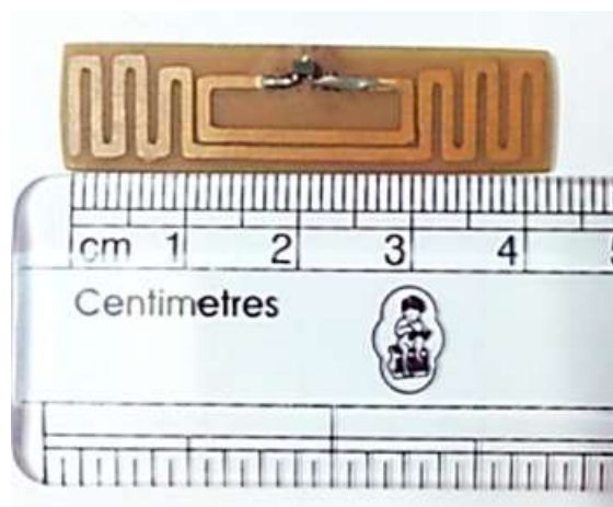
Εικόνα 8: Κεραία γραμμής Μαιάνδρου
