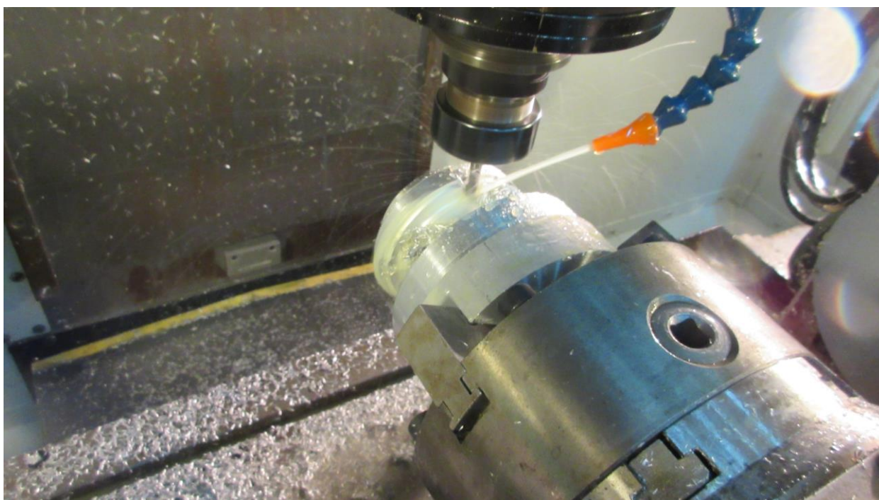
Εικόνα 4.19: Κατεργασία εξωτερικού ξεχονδρίσματος με σφαιρικό κονδύλι.
