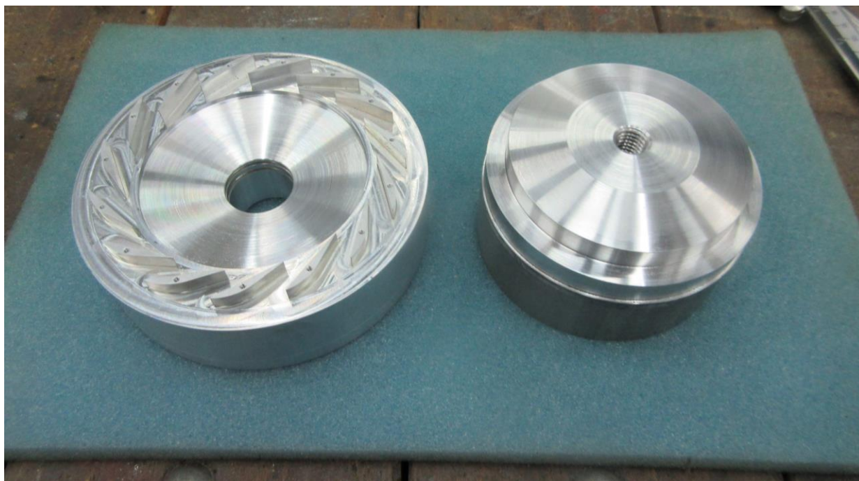
Εικόνα 4.31: Τεμάχιο έτοιμο για τη δεύτερη φάση κατεργασίας και βάση σύσφιξης.
