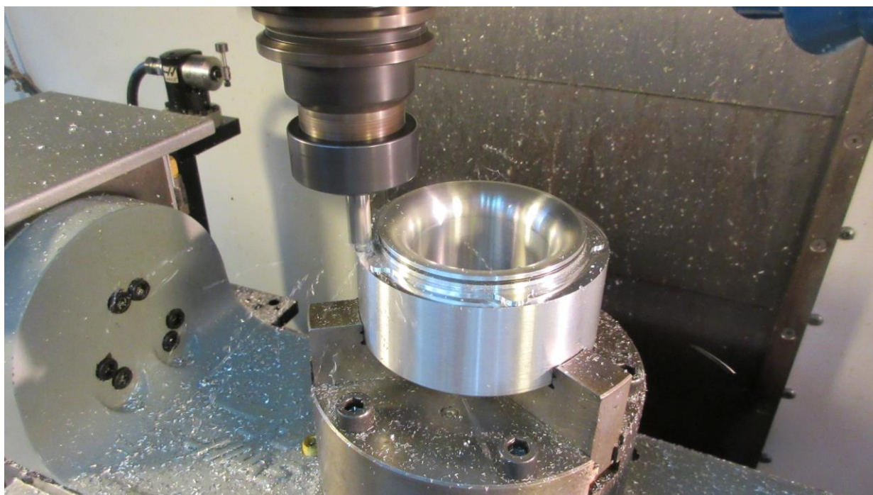
Εικόνα 4.14: Κατεργασία των πέντε οπών συγκράτησης της εισαγωγής στο κέλυφος του διαχύτη.
