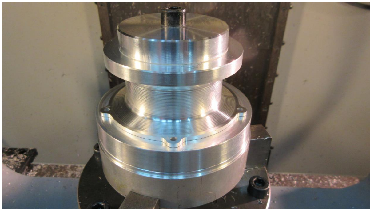
Εικόνα 4.20: Αποτέλεσμα ξεχονδρίσματος.
