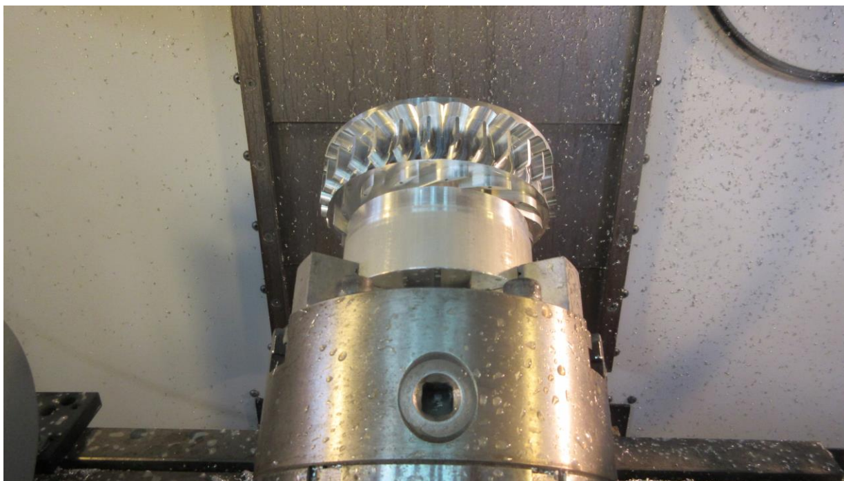
Εικόνα 4.35: Τέλος κατεργασίας αξονικών πτερυγίων.
