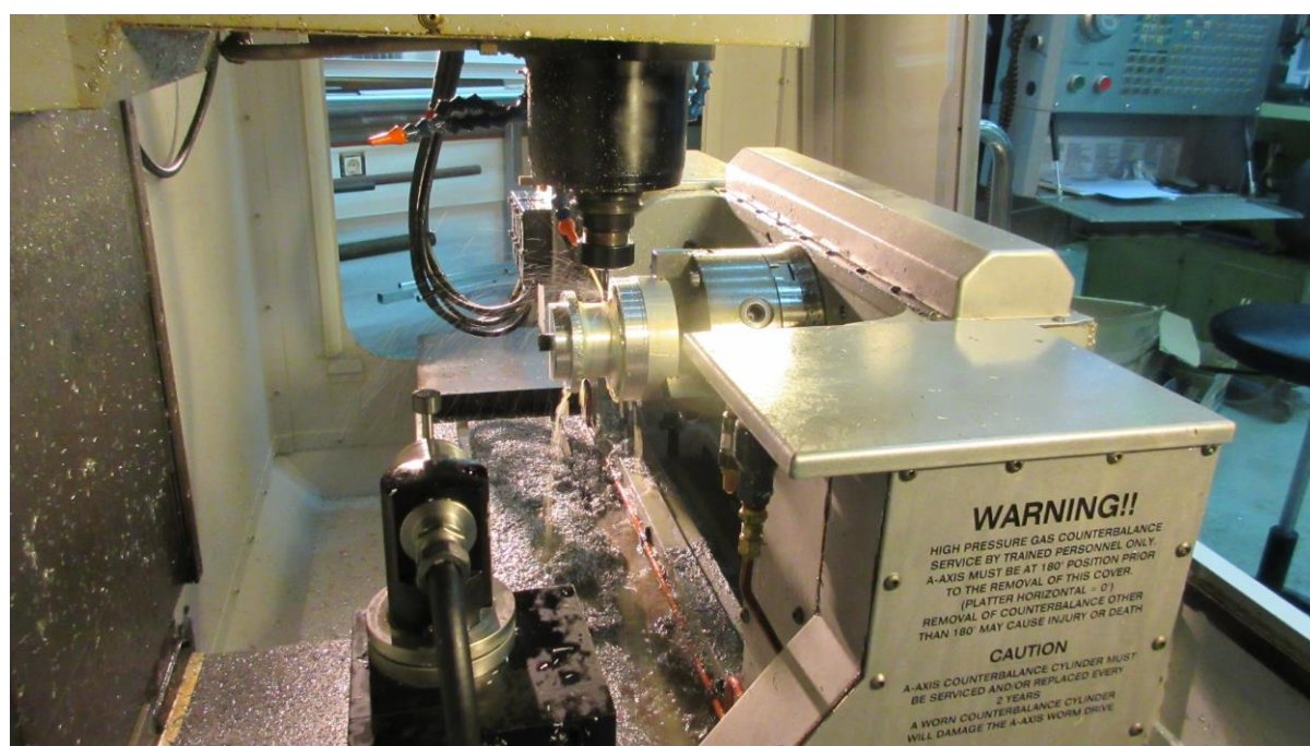
Εικόνα 4.21: Κατεργασία εξωτερικού φινιρίσματος με σφαιρικό κονδύλι.
