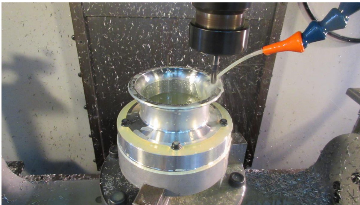
Εικόνα 4.24: Κατεργασία εσωτερικού ξεχονδρίσματος και φινιρίσματος με σφαιρικό κονδύλι.
