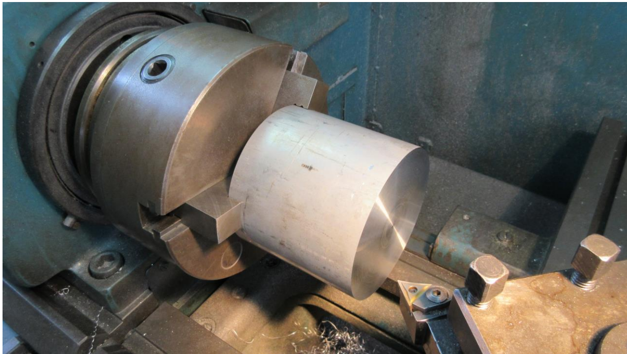
Εικόνα 4.9: Το αρχικό τεμάχιο συγκρατημένο σε σφικτήρα συμβατικού τόρνου.
