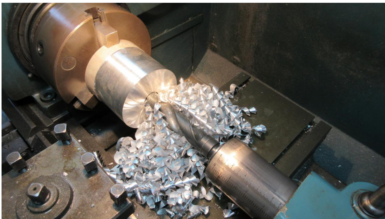
Εικόνα 4.10: Διάνοιξη αρχικής οπής με τρυπάνι.
