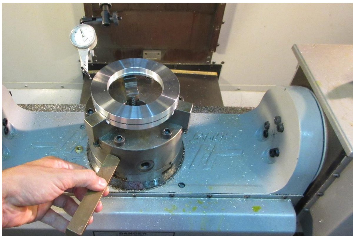
Εικόνα 4.12: Ομοκεντρία τεμαχίου με τον Β άξονα να περιστρέφεται με χαμηλή ταχύτητα.
