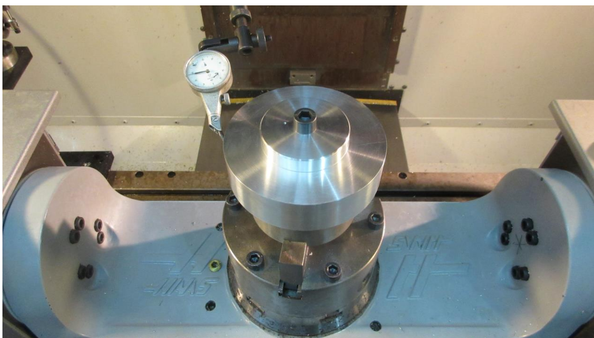
Εικόνα 4.33: Τοποθέτηση, επαλήθευση ομοκεντρίας και σύσφιξη τεμαχίου στη βάση. Το τεμάχιο είναι έτοιμο προς κατεργασία.
