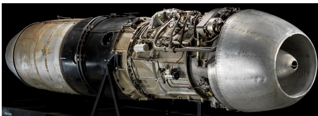
Εικόνα 1.2: Ο κινητήρας Jumo 004 B4 της Junkers σε τομή (πηγή: National Air and Space Museum – Smithsonian).
