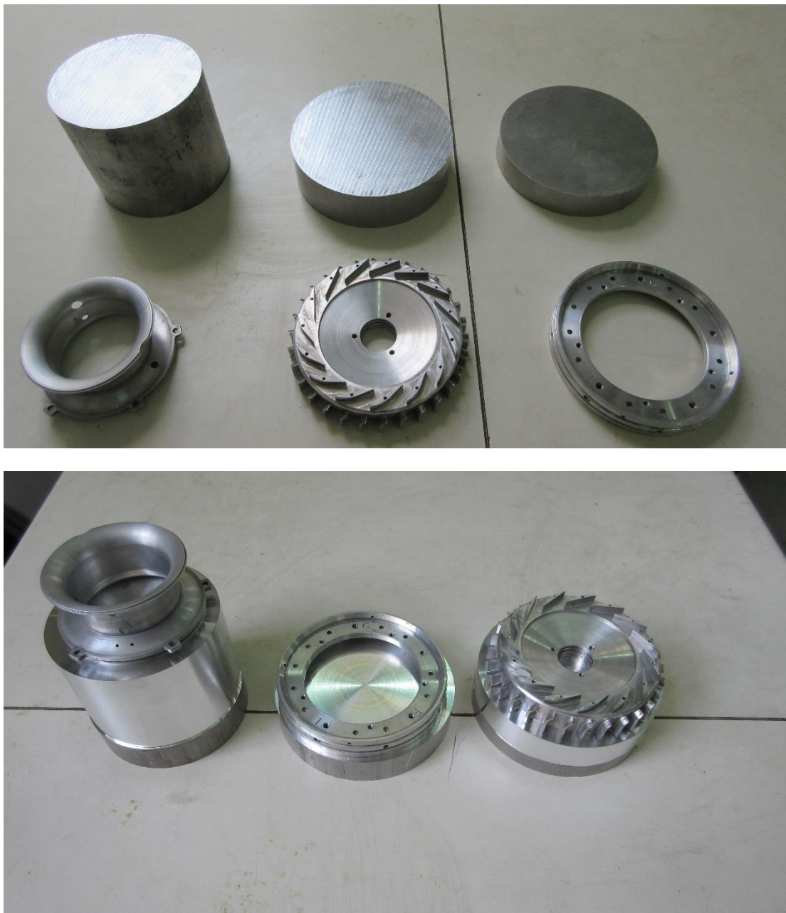
Εικόνα 4.8: Τα αρχικά μεταλλικά τεμάχια και το τελικό αποτέλεσμα της κατεργασίας..
