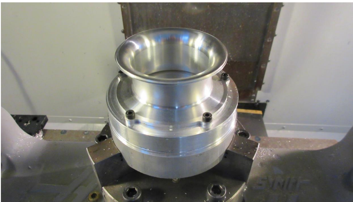
Εικόνα 4.25: Αποτέλεσμα φινιρίσματος και τέλος κατεργασίας.
