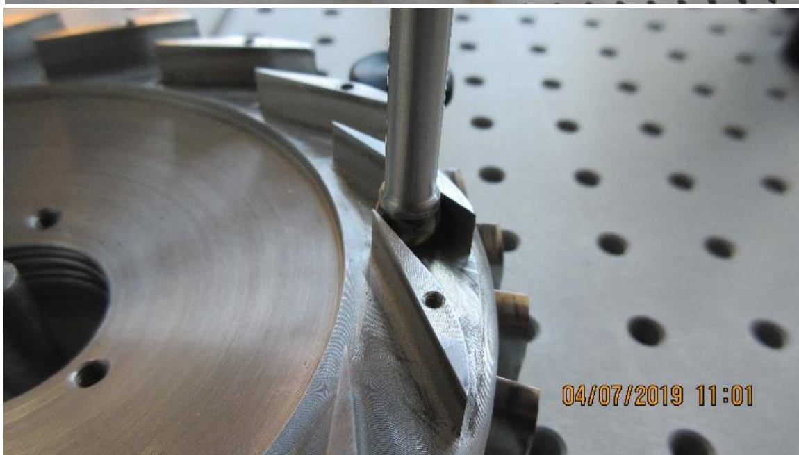
Εικόνα 0.2: Μετρήσεις ακριβείας των διαστάσεων τμημάτων συμπιεστή υπάρχοντος μικρού στροβιλοαντιδραστήρα.
