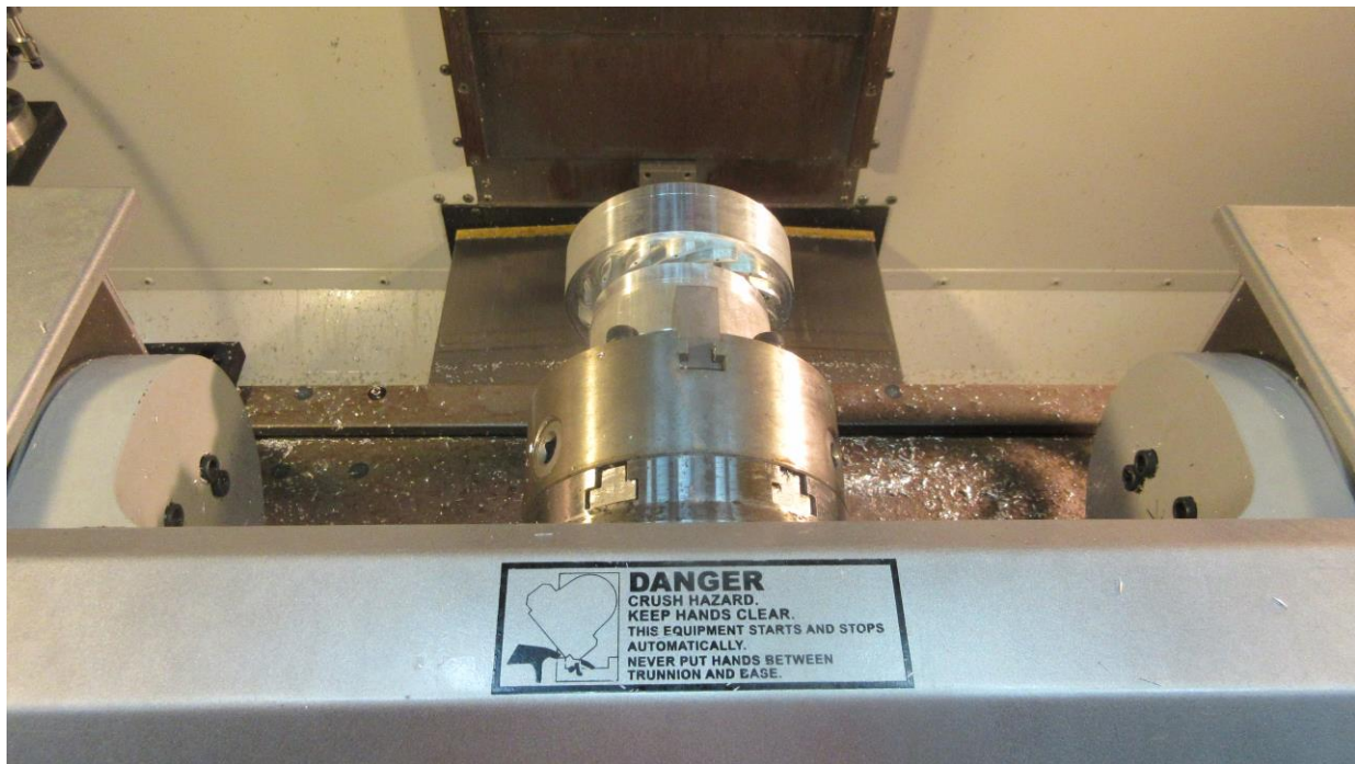
Εικόνα 4.33: Ο Άξονας Α τοποθετείται στις σωστές μοίρες και το τεμάχιο είναι έτοιμο προς κατεργασία.
