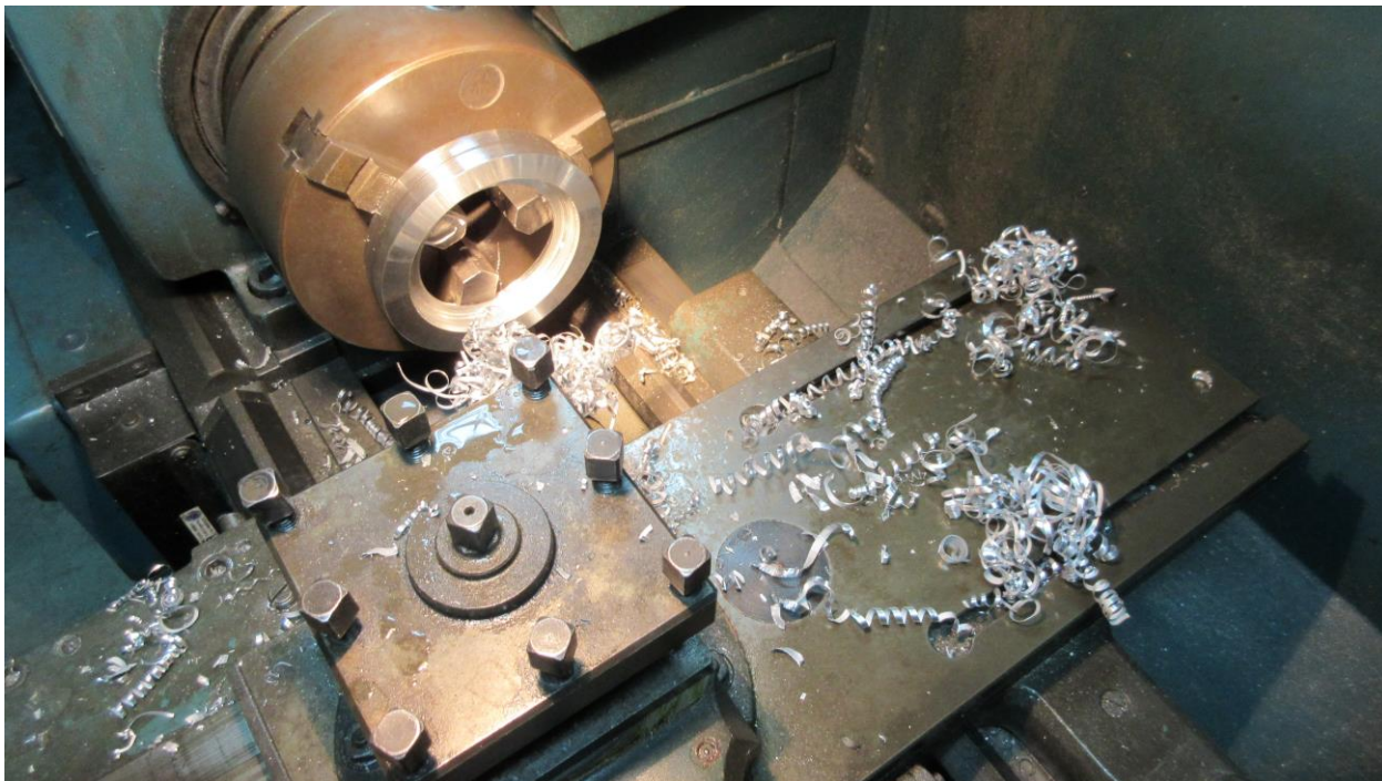
Εικόνα 4.36: Προετοιμασία σε συμβατικό τόρνο.
