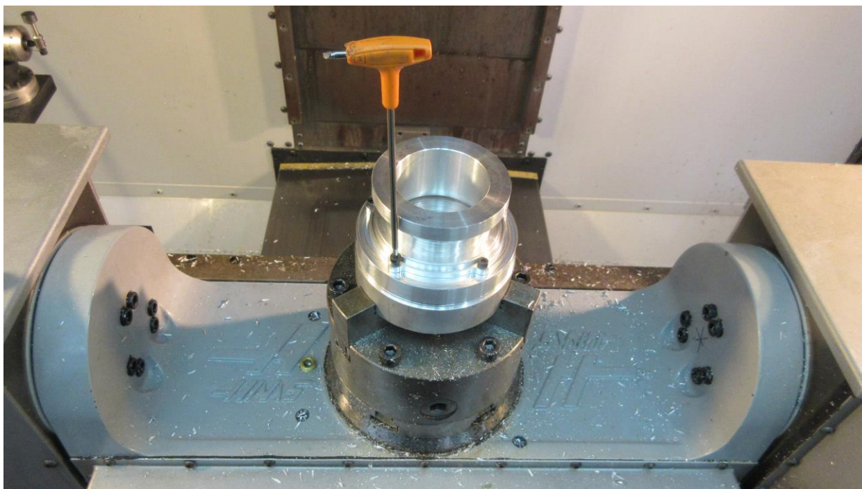
Εικόνα 4.16: Σύσφιξη τεμαχίου στην ειδική βάση, για τη συγκράτηση του τεμαχίου στη Β φάση κατεργασίας.
