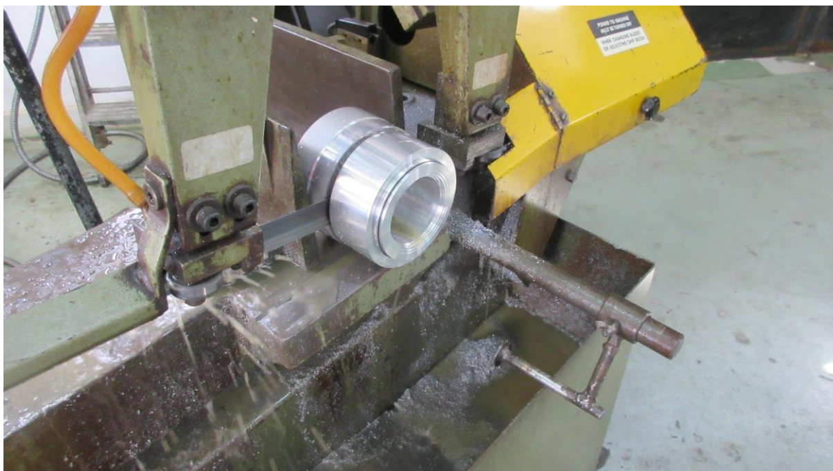
Εικόνα 4.11: Κόψιμο σε πριονοκορδέλα.
