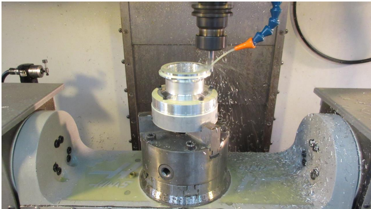
Εικόνα 4.23: Κατεργασία προσώπου τεμαχίου και τελικό ύψος.
