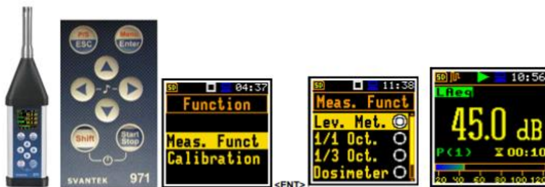
Σχήμα 4.4: Ηχόμετρο SVAN 971, διακόπτες χειρισμού και καταγραφικές ενδείξεις οργάνου [64].
