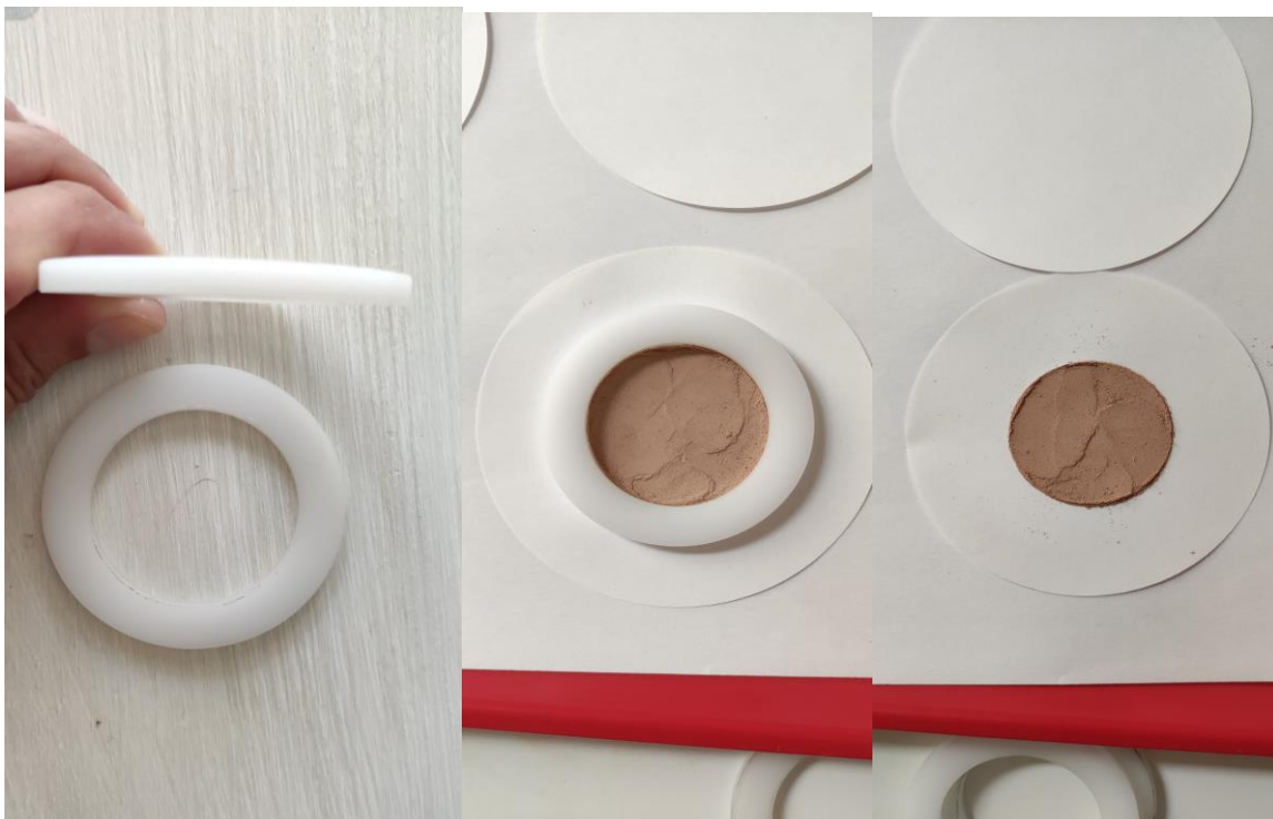
Εικόνα 12 Στην αριστερή εικόνα φαίνεται ο δακτύλιος που κατασκευάστηκε. Στην μεσαία εικόνα φαίνεται πως τοποθετείται το δείγμα στον ηθμό με την βοήθεια του δακτυλίου και δεξιά πως είναι η τελική μορφή του δείγματος.
