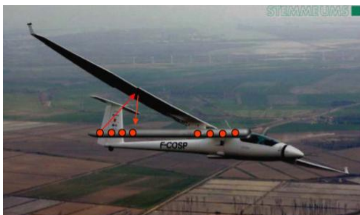
Εικόνα 4.1. Συστοιχία κεραιών σε ΜΕΑ για την εύρεση κατεύθυνσης σήματος [26]
