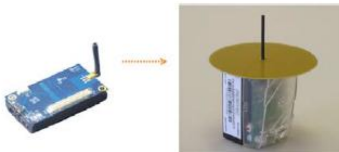
Εικόνα 2.12 Τροποποιημένος Κόμβος - Αισθητήρας για βελτιωμένες πολυκατευθυντικές μετρήσεις RSS [36]
