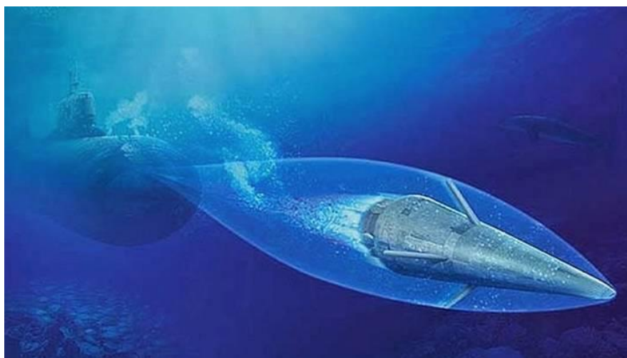
Εικόνα 3.4: Καλλιτεχνική αναπαράσταση τορπίλης υπερσπηλαίωσης στο πεδίο δράσης. ( Πηγή: https://navalnews.net/a-gamechanger-weapon-supercavitating-torpedo/ )
