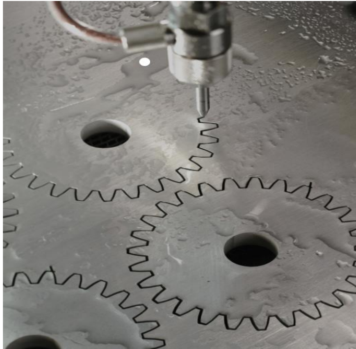
Εικόνα 1.15 Κατασκευή οδοντωτού τροχού με χρήση νερού σε παντογράφο.
