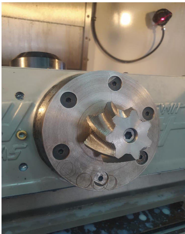
Εικόνα 4.1 Ολοκλήρωση της εκχόνδρισης του δοκιμίου με κοπτικό End Mill
