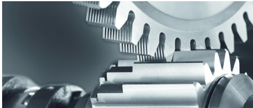
Εικόνα 1.29 Κατασκευή οδοντωτού τροχού με εργαλείο μορφής και διαιρέτη.
