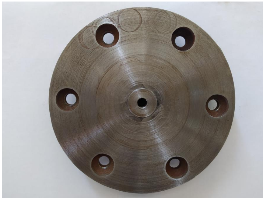
Εικόνα 2.7 Βάση συγκράτησης δοκιμίου.
