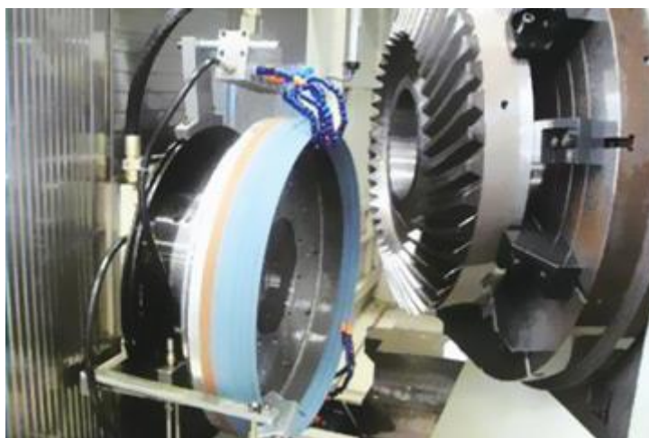
Εικόνα 1.27 Λείανση οδοντωτού τροχού με σπειροειδή οδόντωση.
