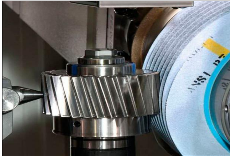
Εικόνα 1.28 Λείανση οδοντωτού τροχού με ελικοειδή οδόντωση.
