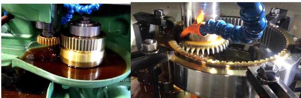
Εικόνα 1.21 Κατασκευή οδοντωτού τροχού με τη μέθοδο Fellows.
