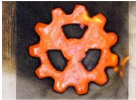
Εικόνα 1.11 Κατασκευή οδοντωτού τροχού με χύτευση σε άμμο.
