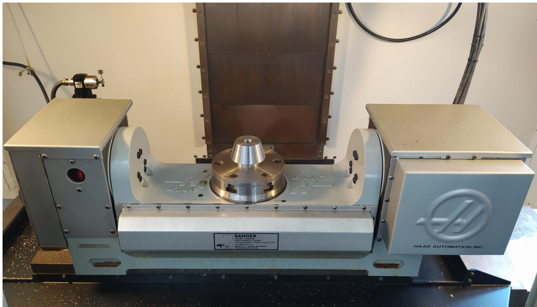
Εικόνα 2.8 Συγκράτηση δοκιμίου στην εργαλειομηχανή.
