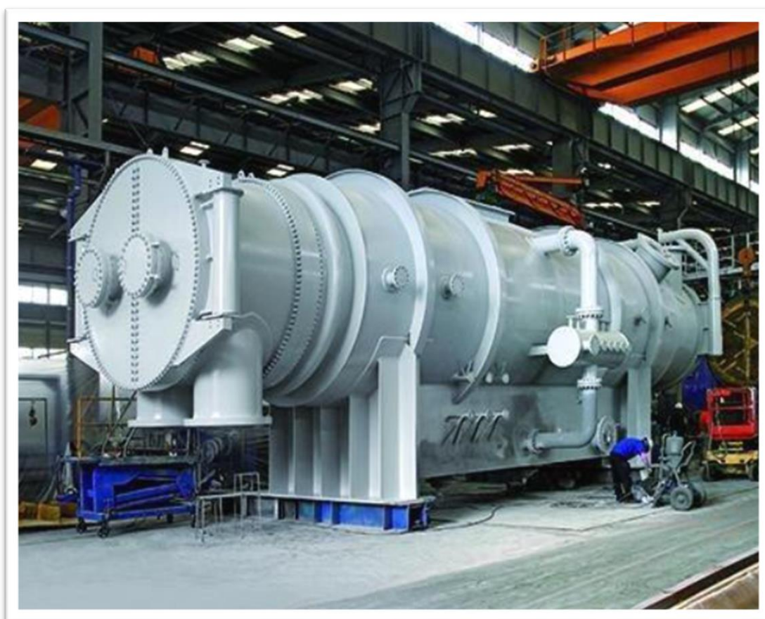
Εικόνα 2.5 Συμπυκνωτής σε μία γεωθερμική μονάδα ηλεκτροπαραγωγής [21]
