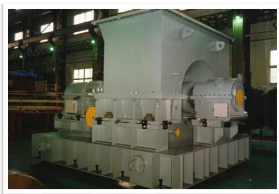
Εικόνα 2.2: Ηλεκτρική γεννήτρια σε γεωθερμικό εργοστάσιο ηλεκτροπαραγωγής [16]
