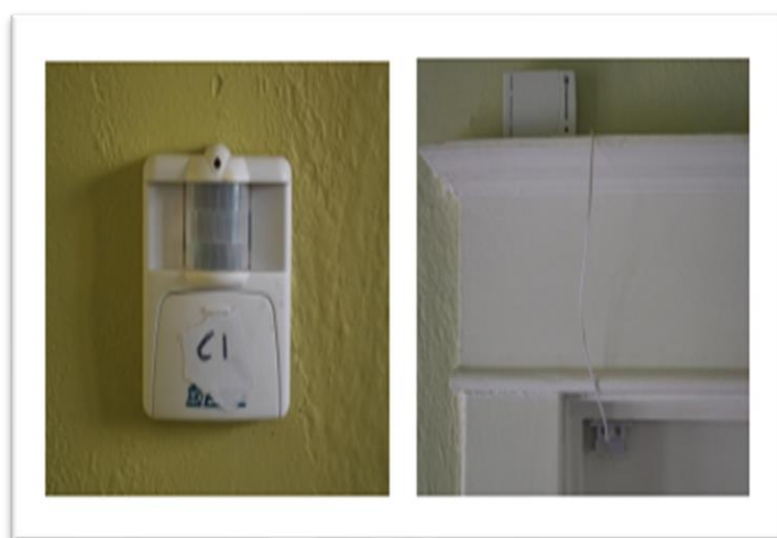
Εικόνα 3.15: Αισθητήρας κίνησης (αριστερά) και μαγνητικός διακόπτης (δεξιά) [35]
