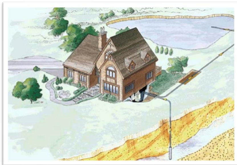
Εικόνα 3.3: Μικτό σύστημα ανοικτού βρόχου [29]
