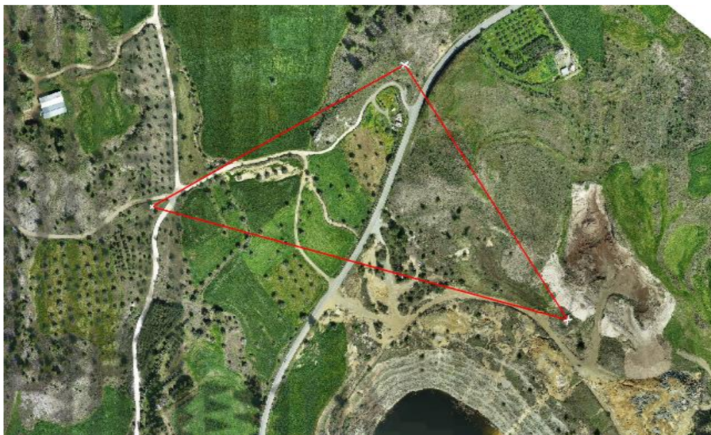
Εικόνα 3.4:Συνένωση Αεροφωτογραφιών και Γεωαναφορά τους στις πραγματικές συντεταγμένες WGS84
