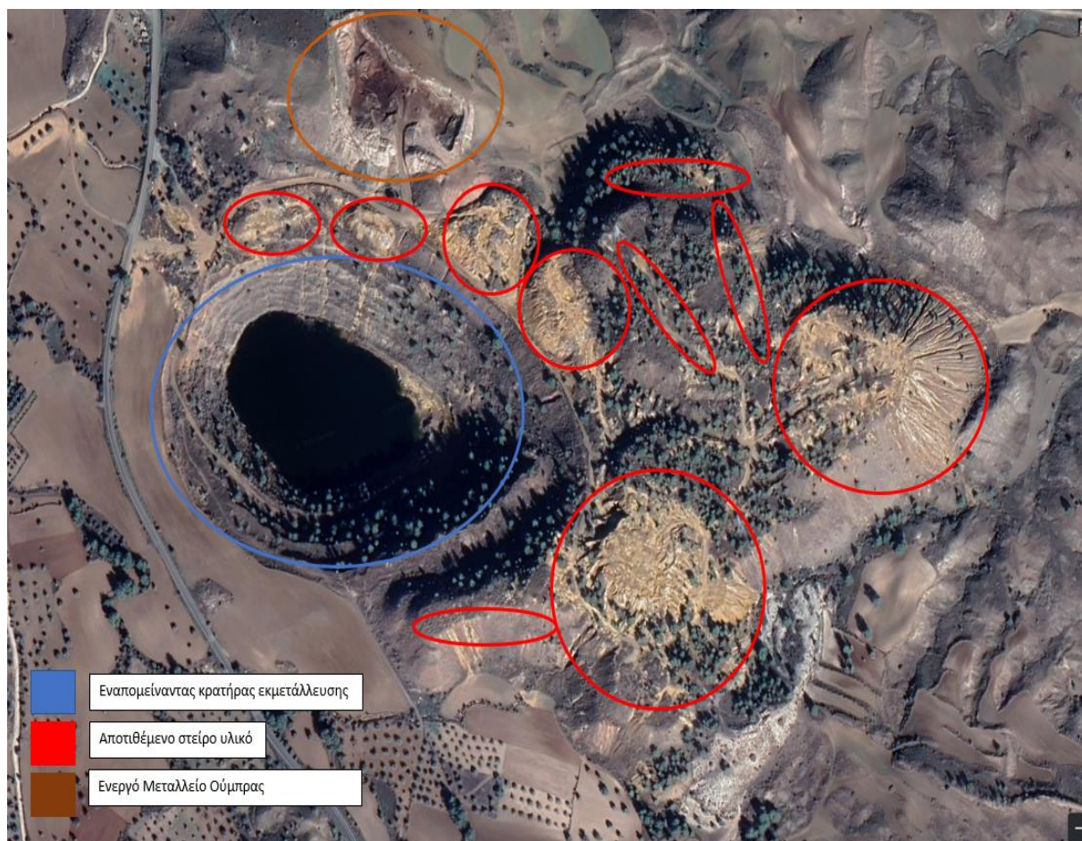
Εικόνα 1.1: Κάτοψη Βόρειου μεταλλείου Μαθιάτη με επισυναπτόμενες τις περιοχές ενδιαφέροντος.
