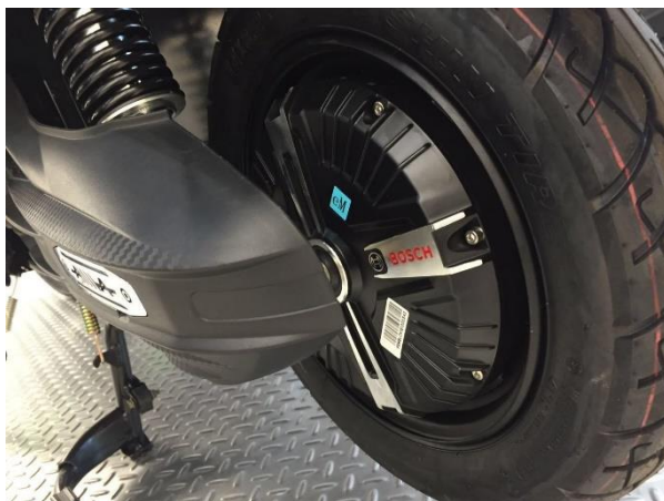
Εικόνα 4: Κινητήρας συνεχούς ρεύματος Τύπου Out-runner Πηγή: https://daytona-electric.gr/model/phos-125/
