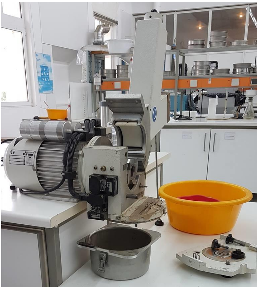
Εικόνα 3.2: Μαχαιρόμυλος τύπου Pulverisette 15
