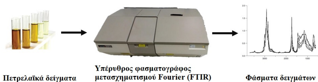
Σχήμα 6.1: Διαδικασία λήψης φασμάτων των πετρελαϊκών κλασμάτων.
