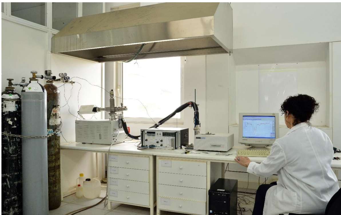
Εικόνα 3.2: Θερμοζυγός τύπου TGA 6, της εταιρίας Perkin Elmer, στο Εργαστήριο Εξευγενισμού και Τεχνολογίας Στερεών Καυσίμων
