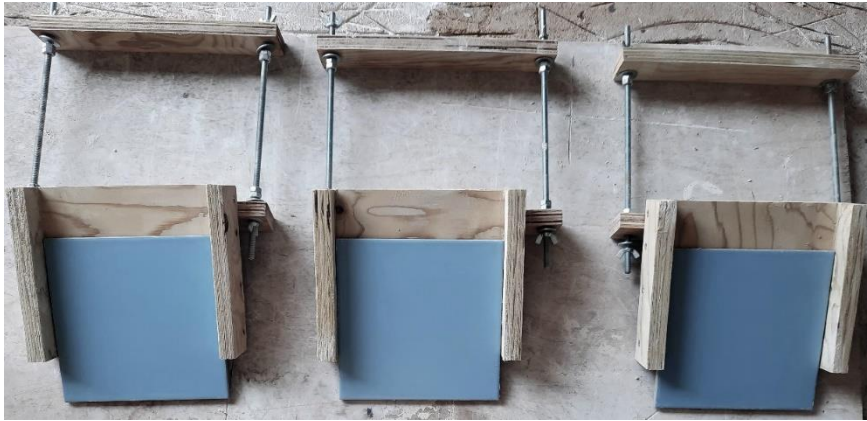
Εικόνα 69: Μήτρα κατασκευής πλακιδίων με προσθήκη λείας επιφάνειας
