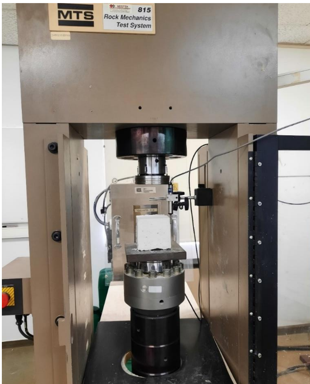
Εικόνα 41: Πρέσα θραύσης δοκιμίων - Δοκίμιο σύνθεσης #18
