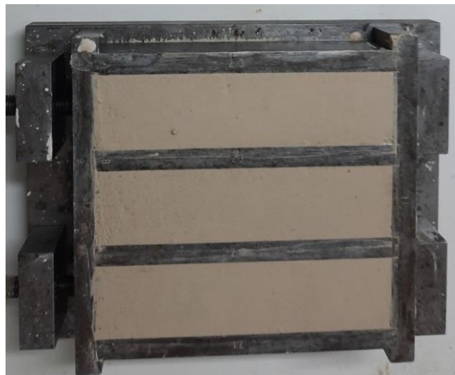
Εικόνα 39: Κονίαμα #16 σε μεταλλική μήτρα (πριν την πήξη)
