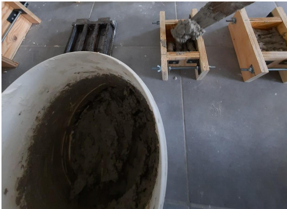
Εικόνα 57: Ανάδευση και Χύτευση κονιάματος #18 σε ξύλινη μήτρα 10x10x10
