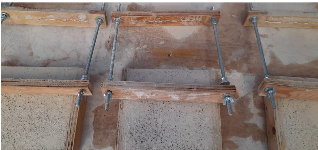
Εικόνα 76: Αφαίρεση πλακιδίων από ξύλινο καλούπι
