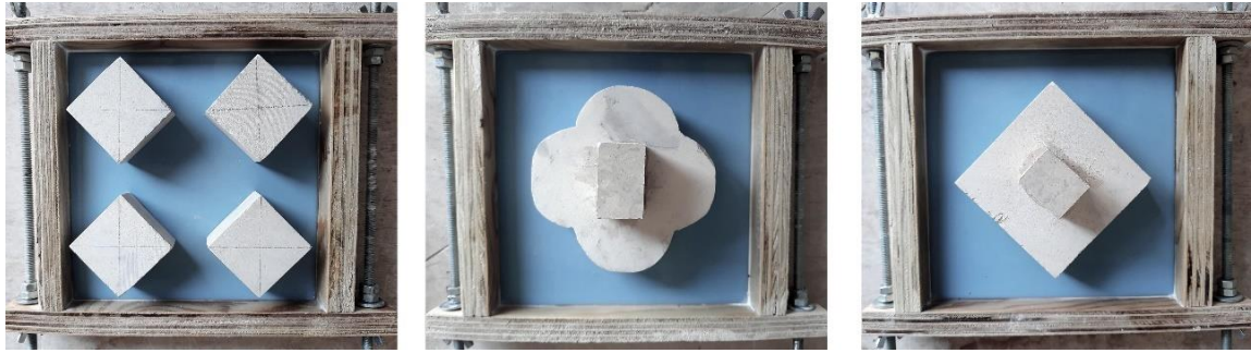
Εικόνα 71: Λίθινη φόρμα μέσα σε ξύλινη μήτρα για κατασκευή πλακιδίων με διαφορετικά χρώματα και μοτίβα
