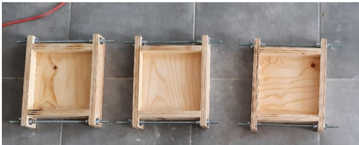
Εικόνα 59: Ξύλινο καλούπι 20x20x3 cm για κατασκευή πλακιδίων
