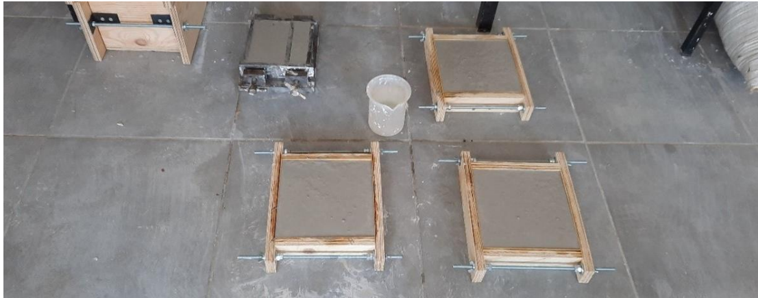
Εικόνα 60: Χύτευση κονιάματος #19 σε καλούπια 20x20x3 cm και 4x4x16 cm
