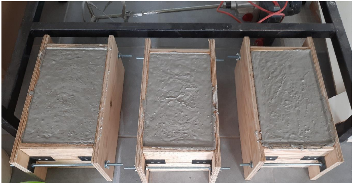
Εικόνα 53: Κονίαμα #17 σε ξύλινο καλούπι (πριν την πήξη)
