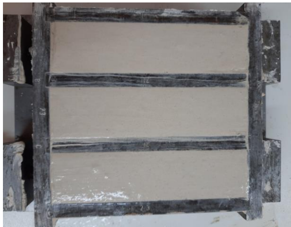
Εικόνα 36: Κονίαμα #13 σε μεταλλική μήτρα (πριν την πήξη)
