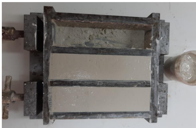
Εικόνα 35: Κονίαμα #9 σε μεταλλική μήτρα (πριν την πήξη)
