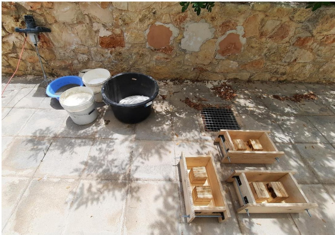
Εικόνα 51: Διαδικασία ανάμειξης υλικών, για χύτευση σε ξύλινο καλούπι κατασκευής πλίνθων
