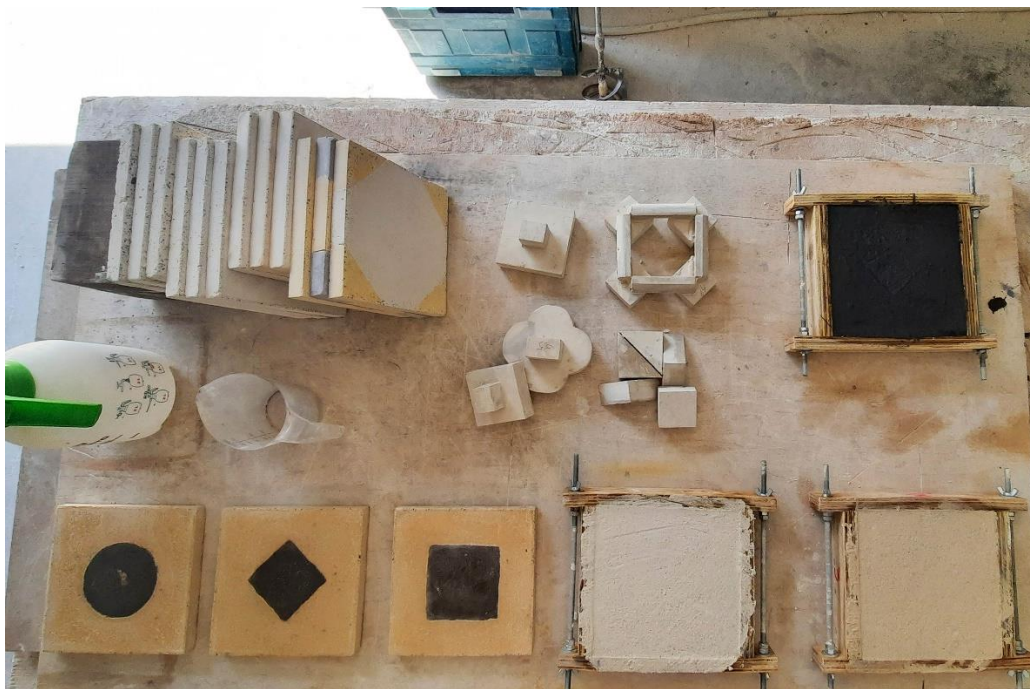
Εικόνα 75: Χύτευση 6ης τριάδας πλακιδίων
