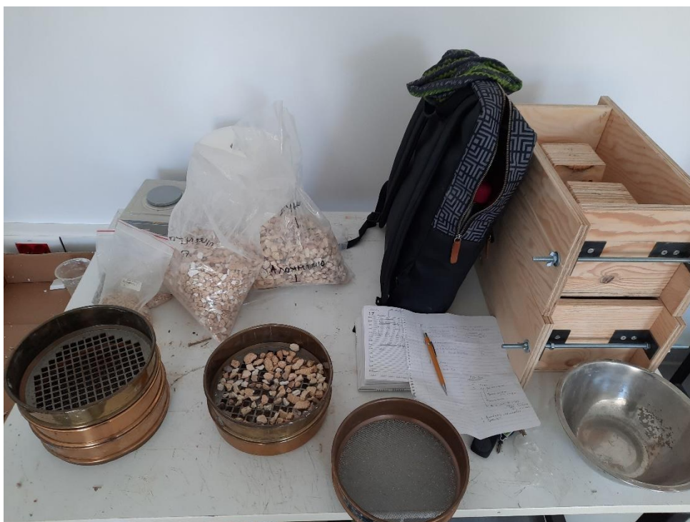
Εικόνα 49: Κοσκίνισμα αδρανών, διαχωρισμός συγκρατούμενων - διερχόμενων
