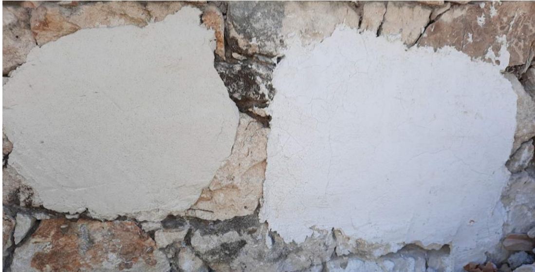
Εικόνα 44: Εφαρμογή υλικού με προσθήκη ινών (νέο υλικό στα αριστερά)
