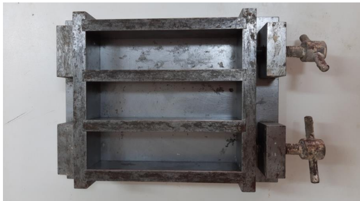
Εικόνα 32: Μεταλλική μήτρα 3x 4x4x16
