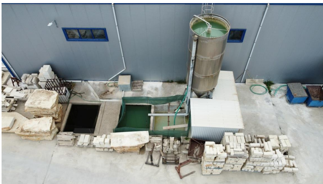
Εικόνα 2: Μονάδα διαχωρισμού λάσπης - νερού και βιολογικού καθαρισμού
