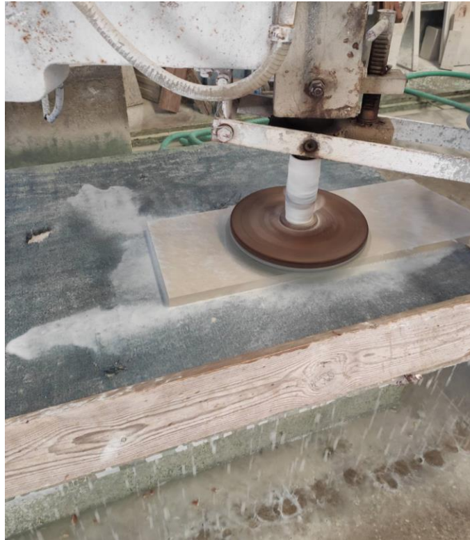
Εικόνα 7: Τέταρτο στάδιο επεξεργασίας - λείανση λίθινων πλακών
