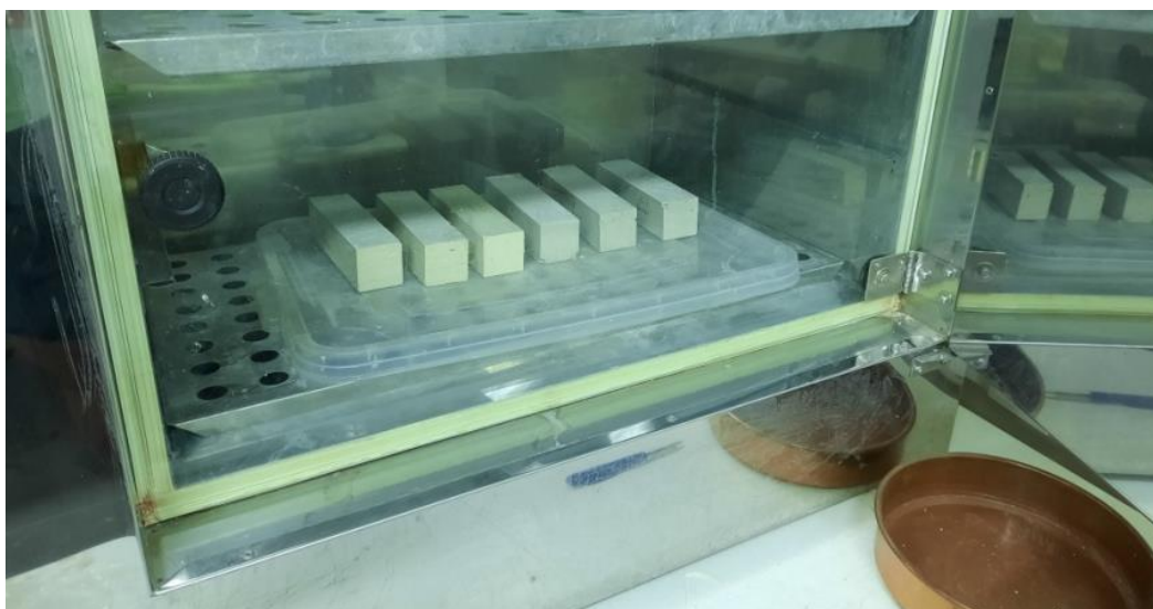
Εικόνα 40: Θάλαμος συντήρησης δοκιμίων 20 °C
