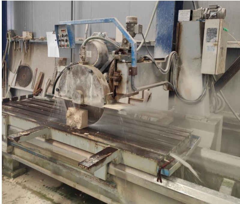
Εικόνα 6: Τρίτο στάδιο επεξεργασίας πέτρας - Κοπή σε μικρότερες διαστάσεις
