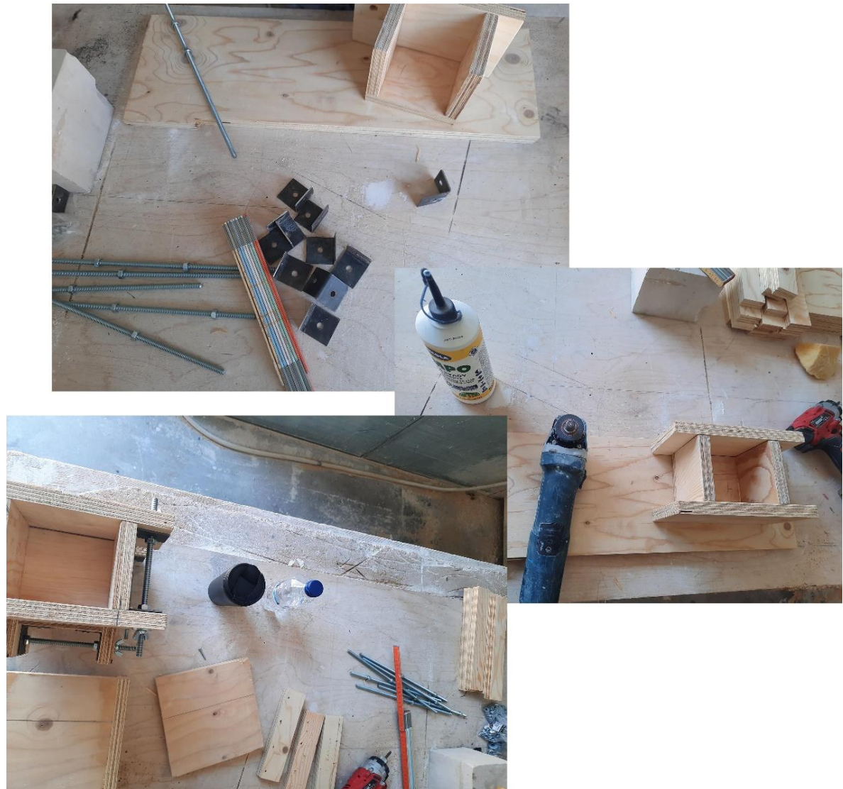
Εικόνα 56: Διαδικασία κατασκευής νέας ξύλινης μήτρας 10x10x10
