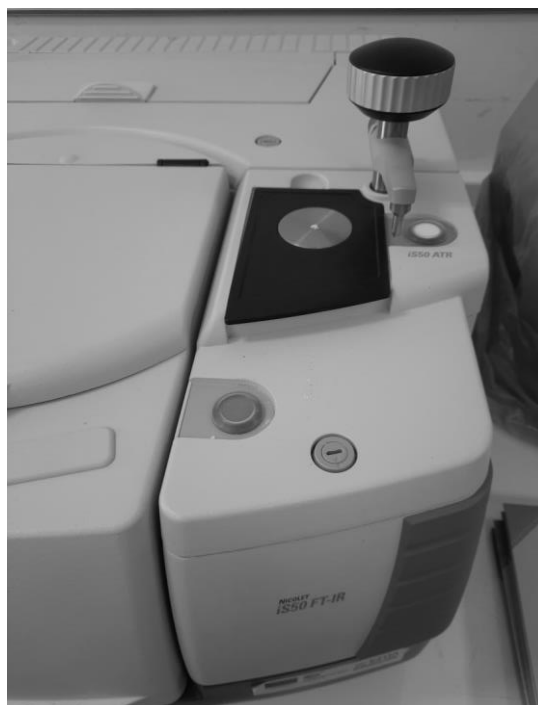
Εικόνα 11: Συσκευή (ανάλυσης _ φασματοσκοπίας) FT - IR
