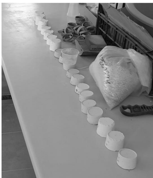
Εικόνα 12: Κονιάματα (16 συνδυασμοί) έπειτα από τη σκλήρυνσή τους
