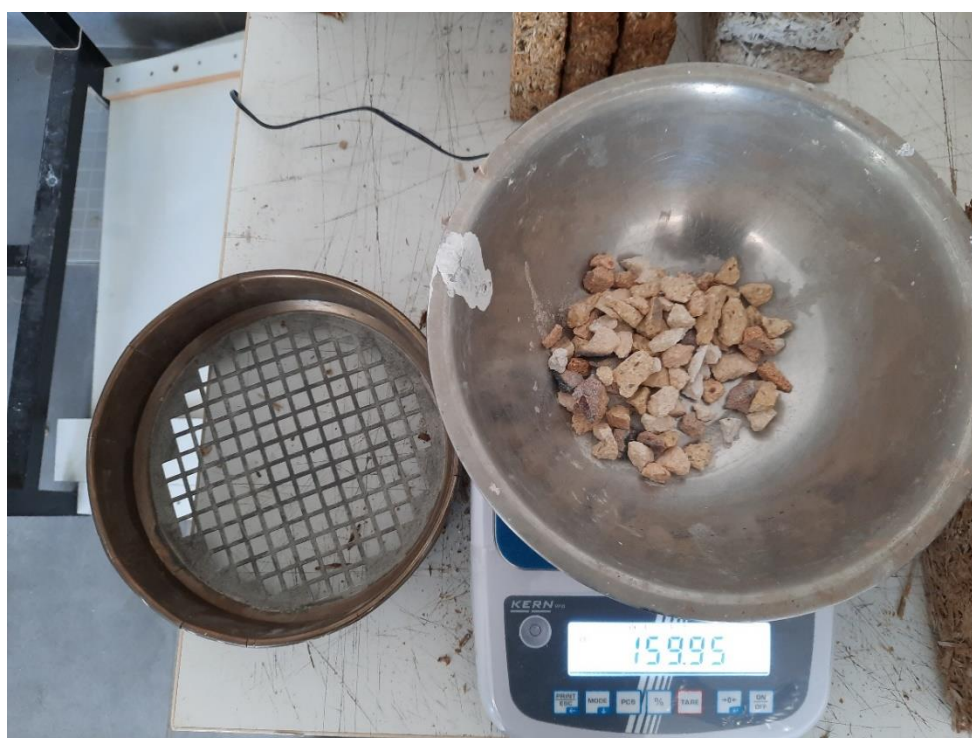
Εικόνα 50: Κοσκίνισμα αδρανών - ζύγιση συγκρατούμενων
