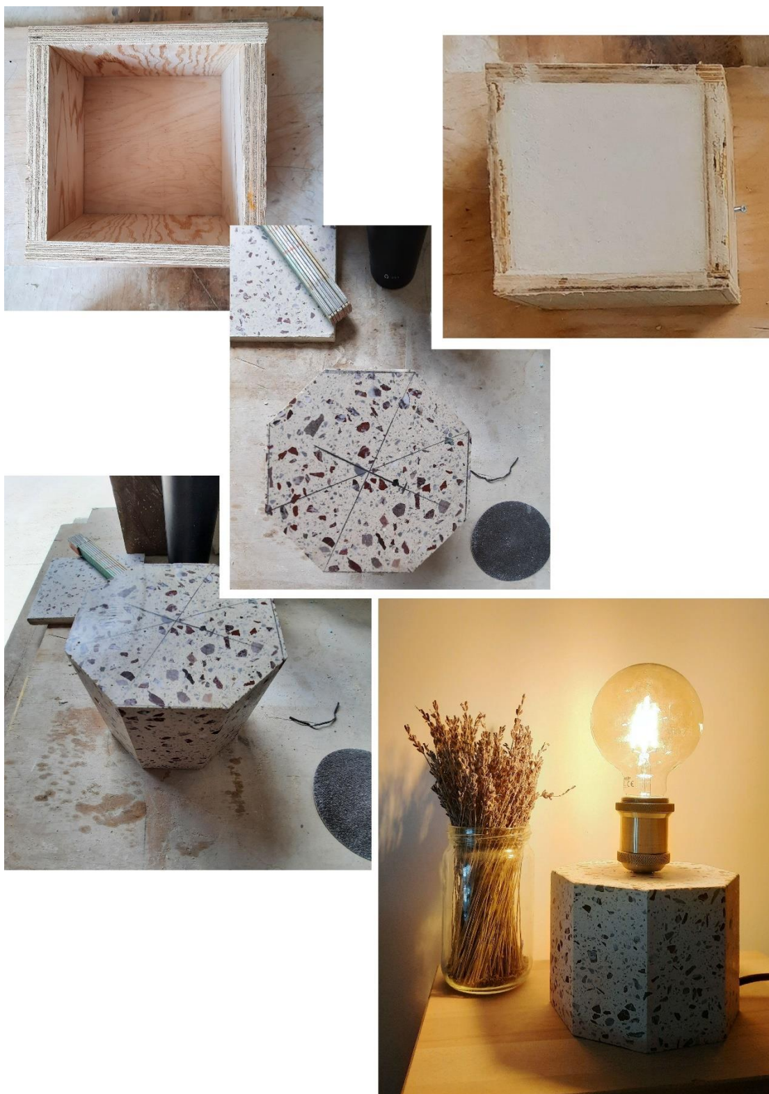
Εικόνα 85: Διαδικασία κατασκευής σύνθεσης για χρήση φωτιστικού I
