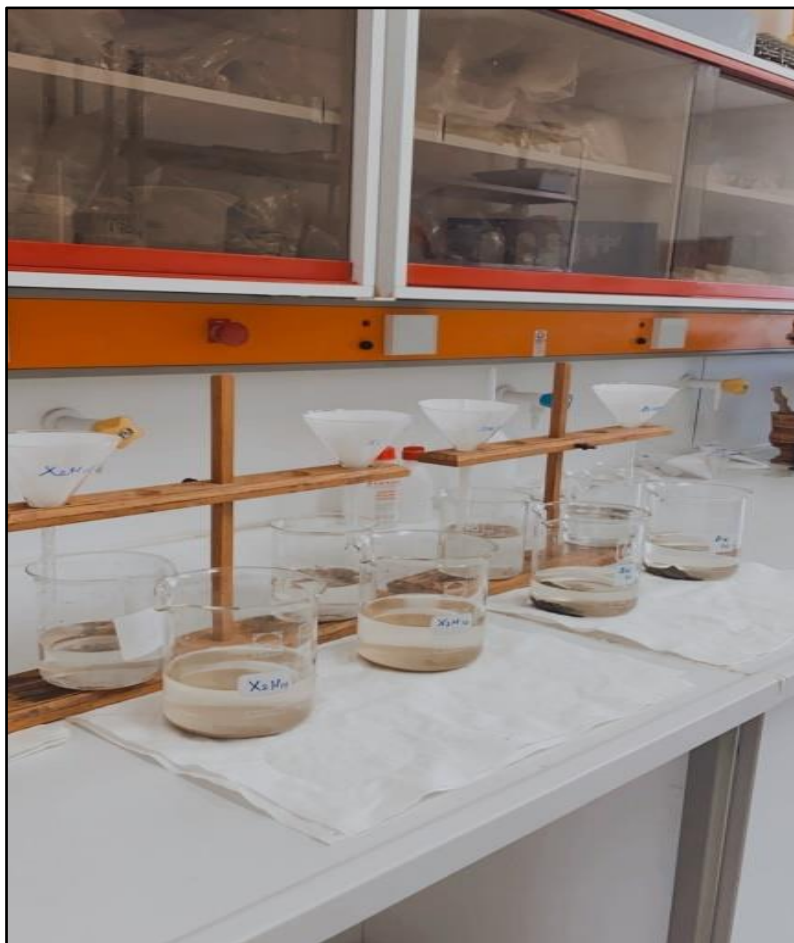
Εικόνα 11: Διαδικασία διήθησης των δειγμάτων μετά την επίδραση διαλύματος οξικού οξέος
