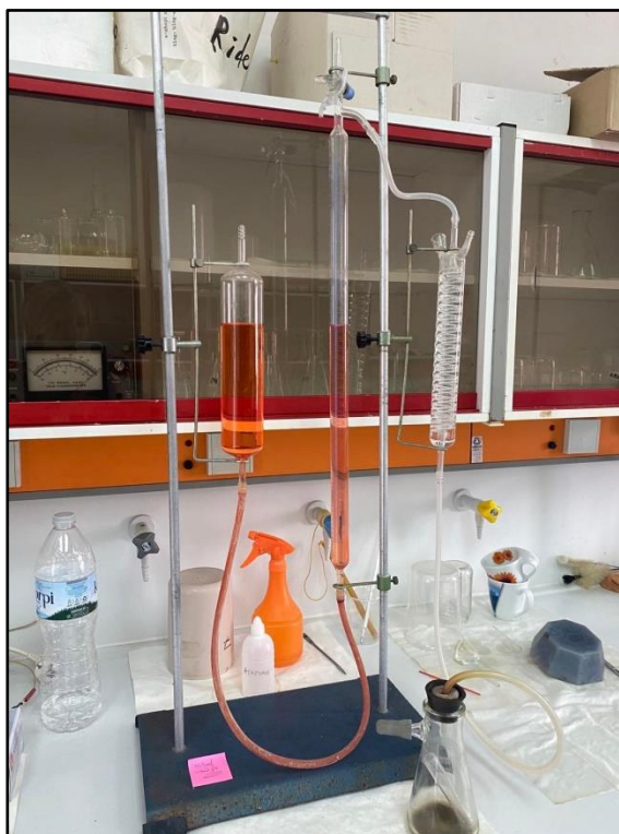
Εικόνα 10: Ασβεστίμετρο τύπου Dietrich-Frueling
