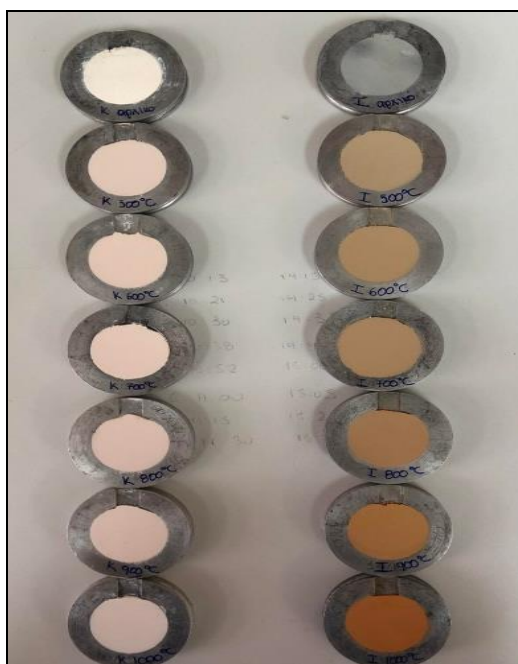
Εικόνα 12: Μεταλλικοί δειγματοφορείς πληρωμένοι με τα αρχικά δείγματα καολίνη/ιλλίτη αλλά και των προϊόντα της έψησης τους, που χρησιμοποιήθηκαν για την ορυκτολογική ανάλυση των δειγμάτων.
