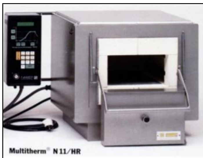
Εικόνα 11: Ηλεκτρικός κλίβανος υψηλών θερμοκρασιών του Εργαστηρίου Πετρολογίας και Οικονομικής Γεωλογίας.
