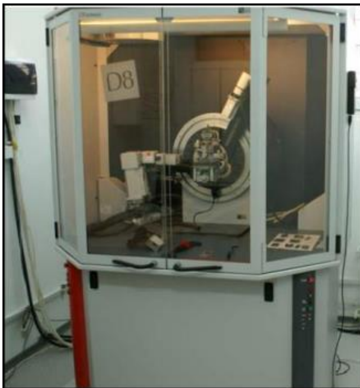
Εικόνα 8: Περιθλασίμετρο ακτίνων-X (XRD) τύπου D8-Advance (Brucker AXS), του Εργαστηρίου Γενικής & Τεχνικής Ορυκτολογίας της Σχολής Μηχ. Ο. Π.
