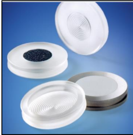
Εικόνα 9 :Διαφόρων τύπων ειδικοί δειγματοφορείς που χρησιμοποιούνται στη μέθοδο της περιθλασιμετρίας ακτίνων-Χ (XRD).
