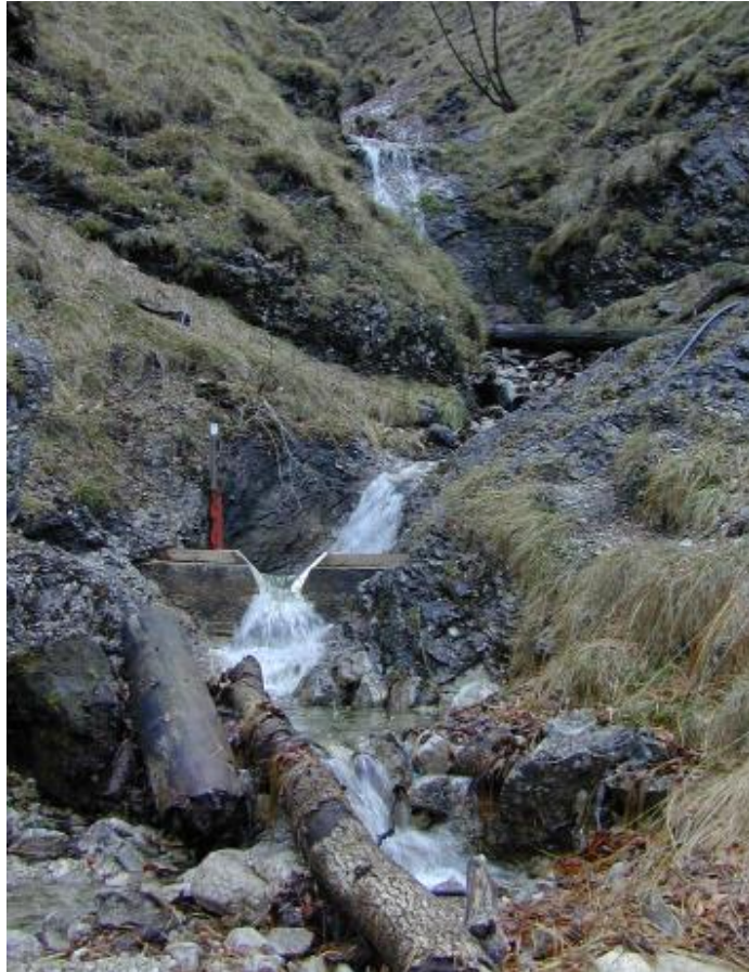
Σχήμα 2.10. Υδατοφράκτης με σταθμό μέτρησης απορροής [Proell, Dirnboeck, 2022 (1)]
