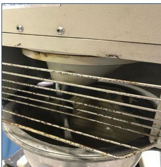
Εικόνα 20. Μηχανικός αναμικτήρας κονιαμάτων του Εργαστηρίου Πετρολογίας.
