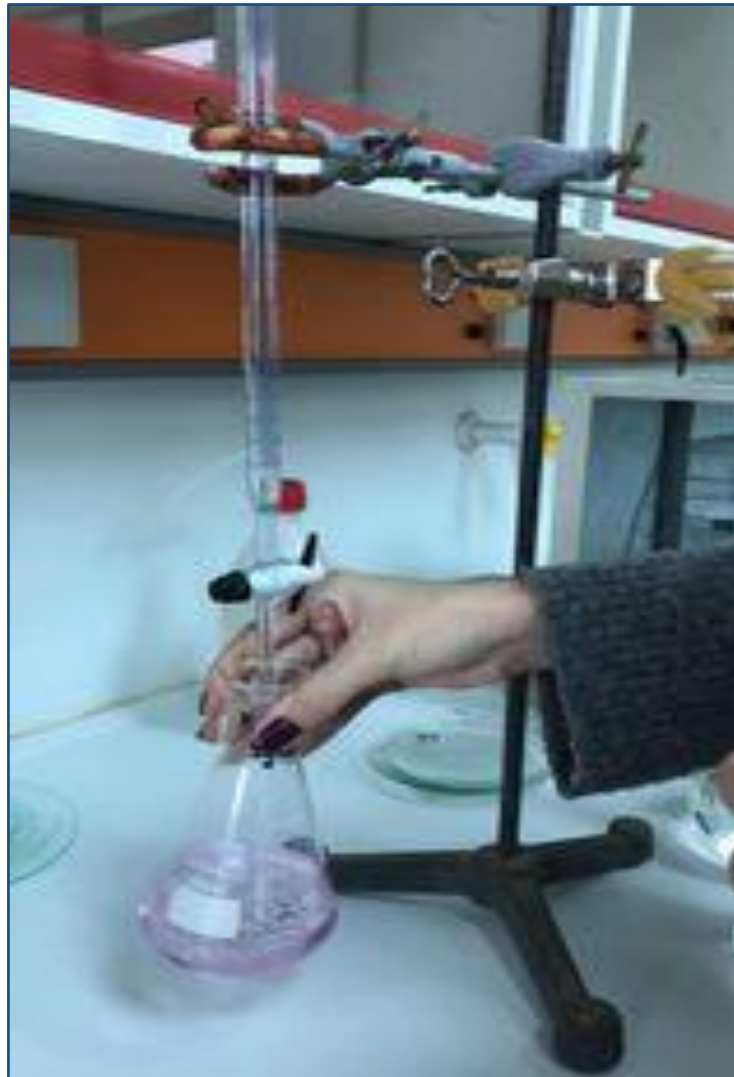
Εικόνα 17. Τιτλοδότηση διαλύματος με δείκτη φαινολοφθαλεΐνης.
