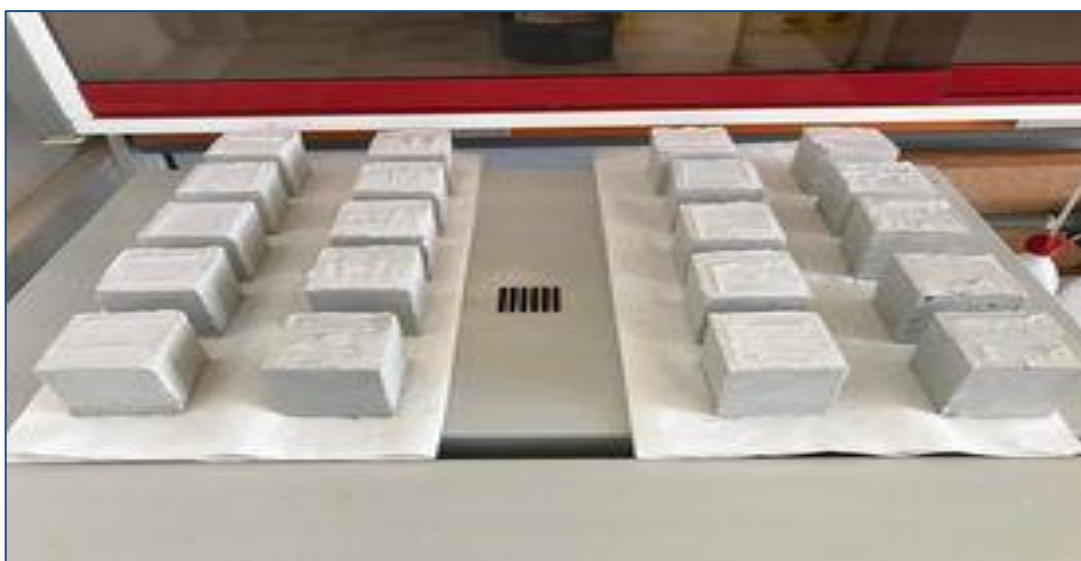
Εικόνα 22. Δοκίμια από την ανάμειξη του δείγματος της ποζολάνης της εταιρείας LAVA Νίσυρος με υδράσβεστο.
