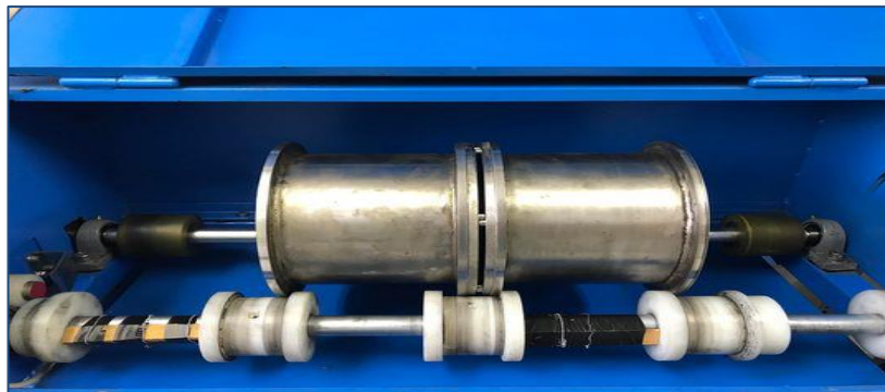
Εικόνα 18. Συσκευή Micro-Deval που πραγματοποιήθηκε η ανάμειξη των υλικών με την χρήση τυμπάνων.
