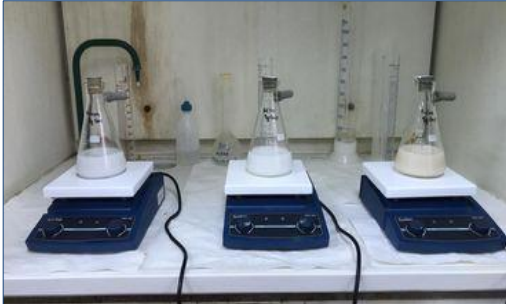
Εικόνα 16. Διαλύματα ποζολάνης με προσθήκη CaO για την εκτέλεση της εργαστηριακής δοκιμής Chapelle.
