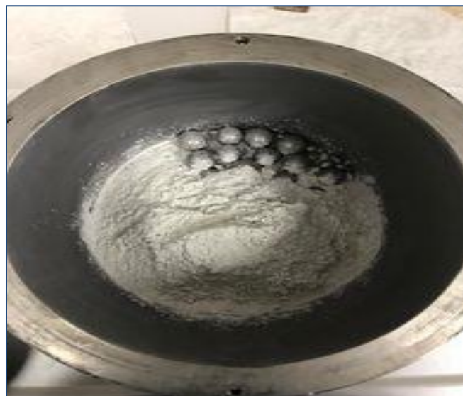
Εικόνα 19. Εσωτερικό τυμπάνου μετά την ολοκλήρωση της διαδικασίας συνάλεσης των κονιών, με τη χρήση χαλύβδινων σφαιρών.
