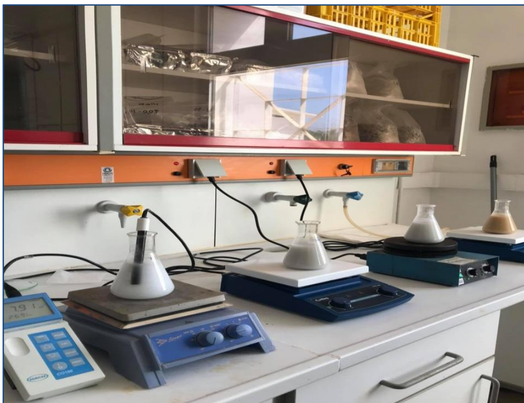
Εικόνα 15. Εργαστηριακή διάταξη πραγματοποίησης της εργαστηριακής δοκιμής μεταβολής της αγωγιμότητας κορεσμένων διαλυμάτων υδρασβέστου.
