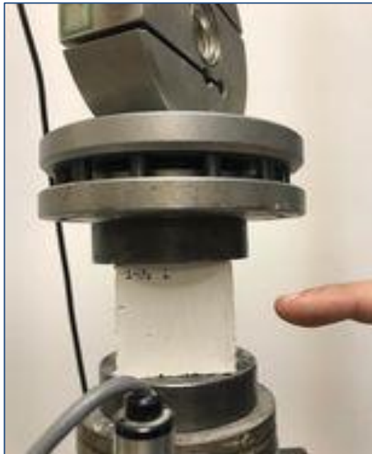
Εικόνα 23. Δοκιμή μονοαξονικής θλίψης
