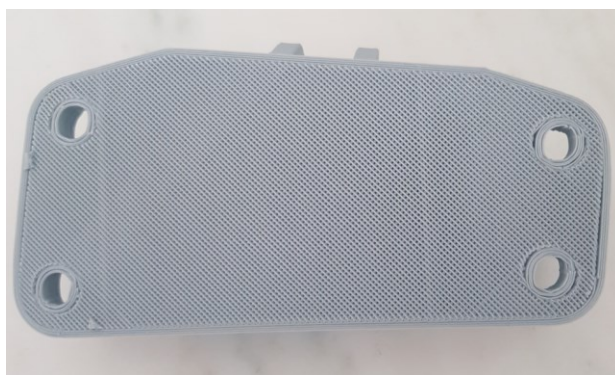
Εικόνα 99: Το μη βελτιστοποιημένο μοντέλο από διάφορες οπτικές γωνίες μετά την αφαίρεση των στηριγμάτων.
