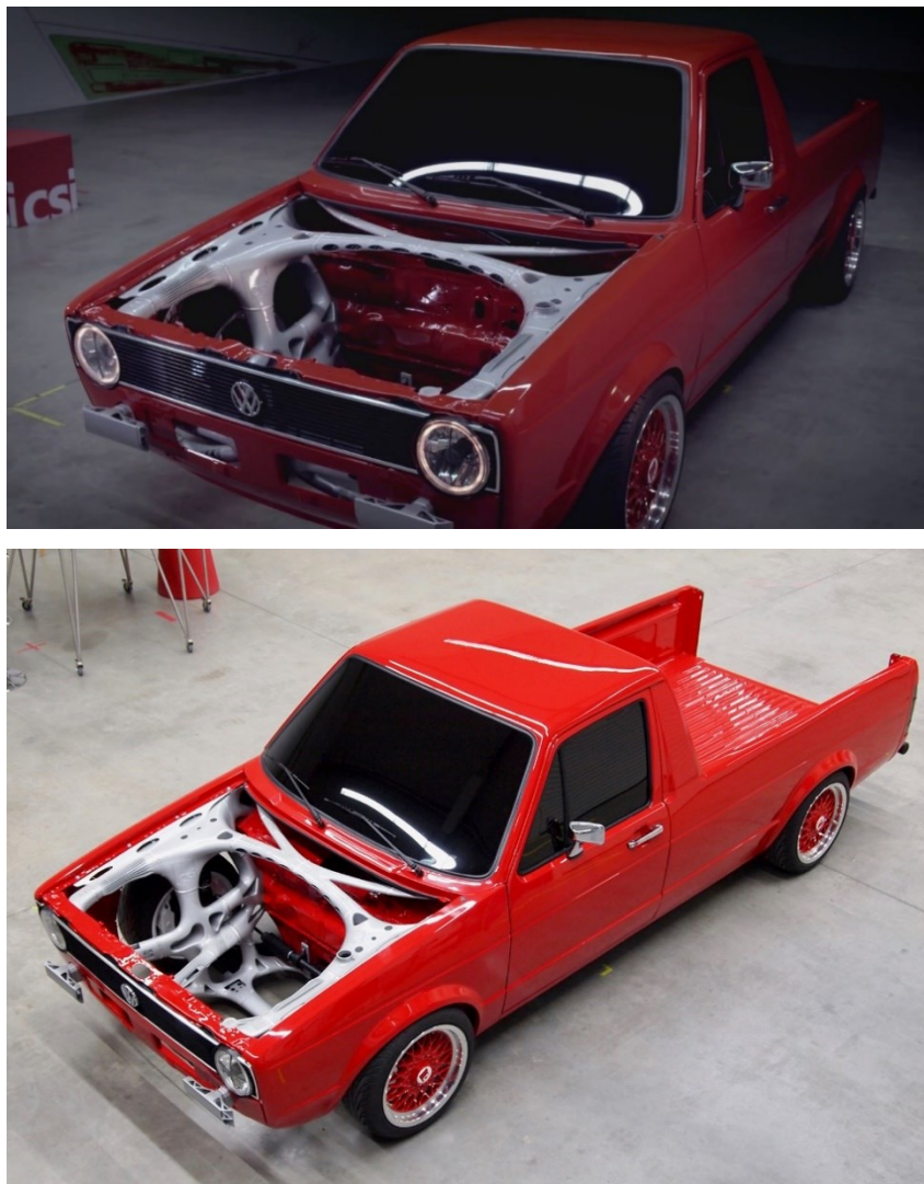
Εικόνα 19 : Project 3i-PRINT σε Volkswagen Caddy [24].
