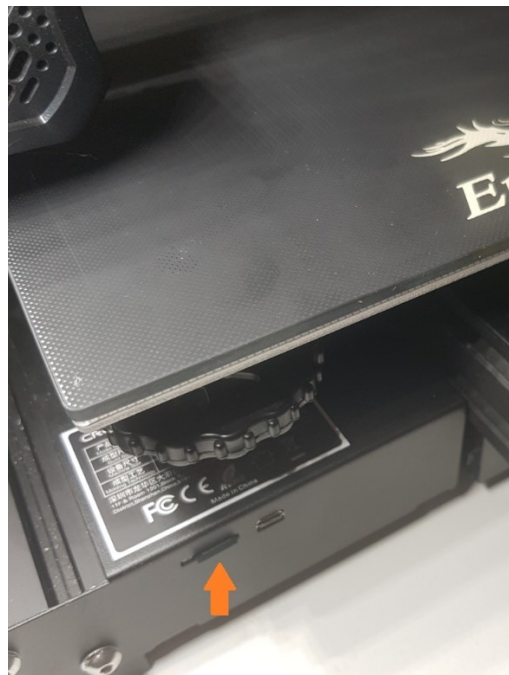
Εικόνα 95: Είσοδος μέσου μεταφοράς στον Ender 3 V2.
