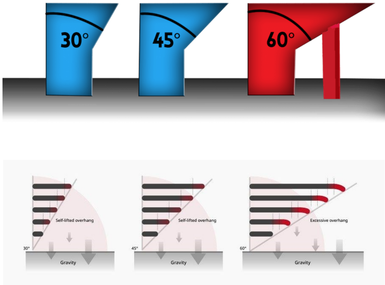
Εικόνα 47: Η επίδραση του overhang angle κατά την εκτύπωση [47, 48].
