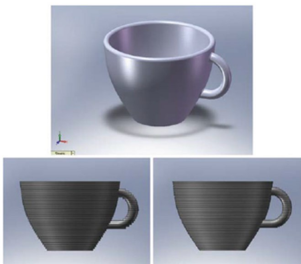
Εικόνα 3: Απεικόνιση ενός τρισδιάστατου ψηφιακού μοντέλου (επάνω) και η επίδραση που έχουν σε αυτό διαφορετικά πάχη των στρώσεων (κάτω) [4]
