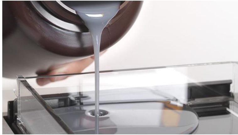
Σχήμα 2.14.2: Το φωτοπολυμερές της τεχνολογίας SLA
