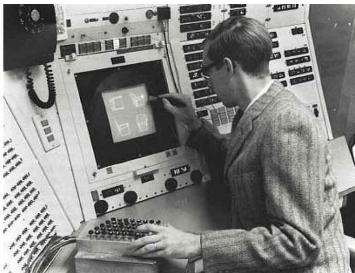
Σχήμα 2.3.1: Εκτέλεση του Sketchpad από τον Ivan Sutherland σε έναν TX-2 υπολογιστή
