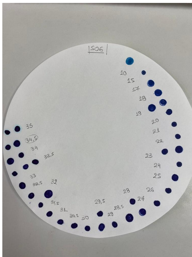
Εικόνα 16: Διηθητικό χαρτί δείγματος S06, με σταγόνες στερεού μπεντονίτη με τελικό σημείο τα 35 ml κυανού του μεθυλενίου μετά από εμφάνιση "μπλε άλω".
