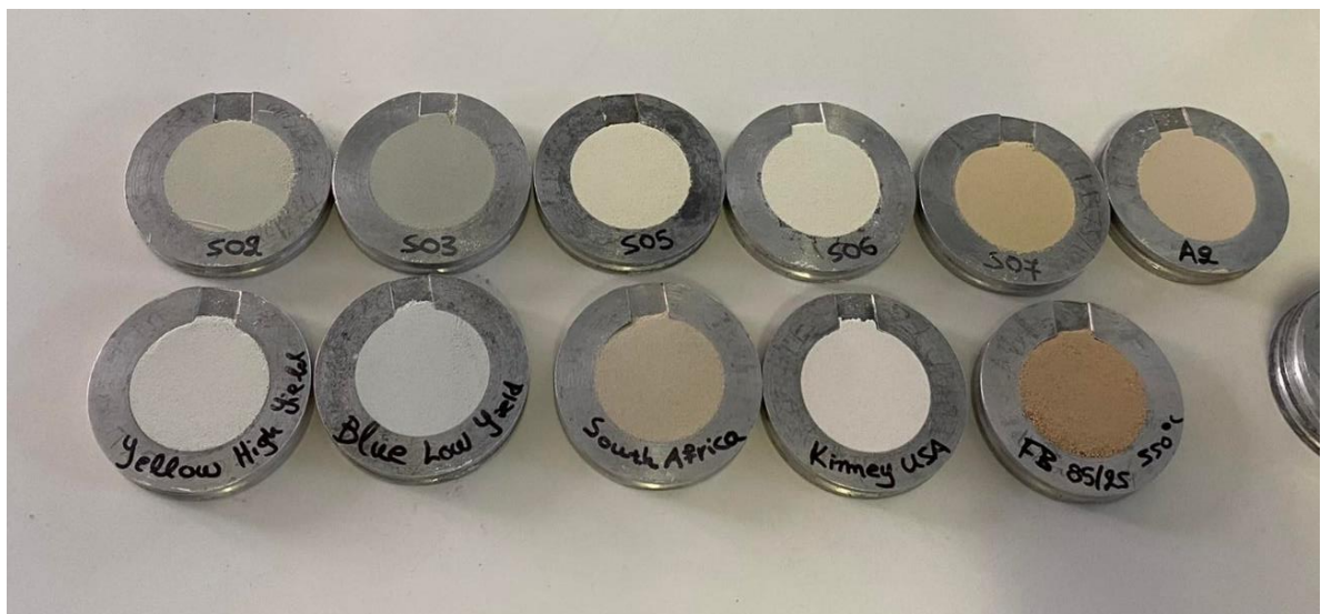
Εικόνα 8: Δειγματοφορείς γεμισμένοι με πούδρα δειγμάτων προς εξέταση σε περιθλασίμετρο ακτίνων Χ (XRD).
