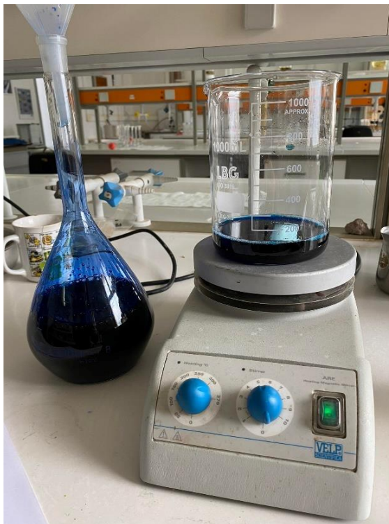
Εικόνα 18: Παρασκευή του διαλύματος κυανού του μεθυλενίου .
