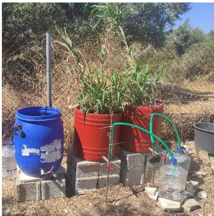
Εικόνα 10. Πιλοτικές μονάδες τεχνητών υγροβιότοπων στο Πολυτεχνείο Κρήτης. Στα αριστερά ο υγροβιότοπος Control (CWC) με HDPE ως πληρωτικό υλικό, στη μέση ο CWP με βλάστηση και HDPE και τέλος στα δεξιά ο CWG με βλάστηση και χαλίκι.
