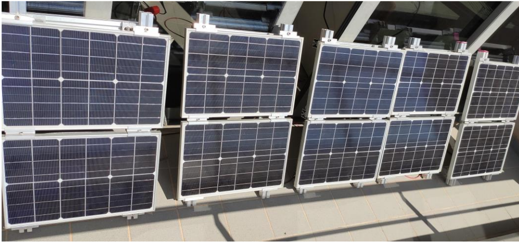
Εικόνα 116: Πειραματική διάταξη φωτοβολταϊκής συστοιχίας.
