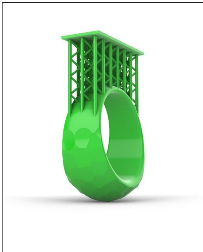
Εικόνα 5: Εκτυπωμένο αντικείμενο με τις απαραίτητες στηρίξεις
