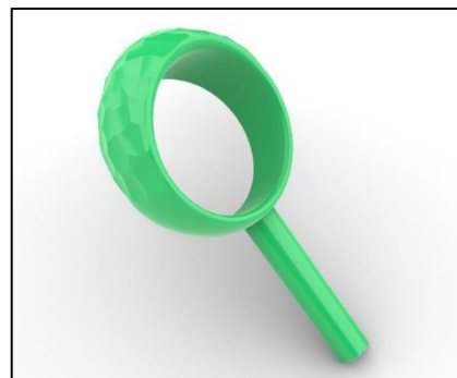
Εικόνα 8: Κατασκευή κέρινου πρωτοτύπου σε τρισδιάστατο εκτυπωτή
