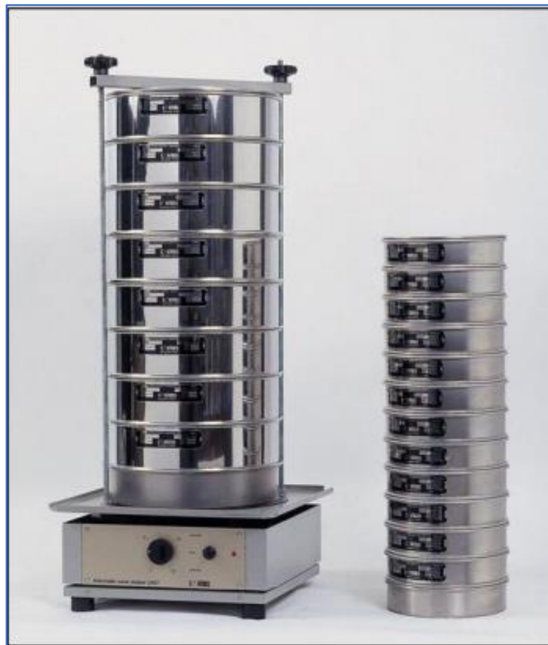
Εικόνα 29. Σειρά κοσκίνων με δονούμενη τράπεζα.
