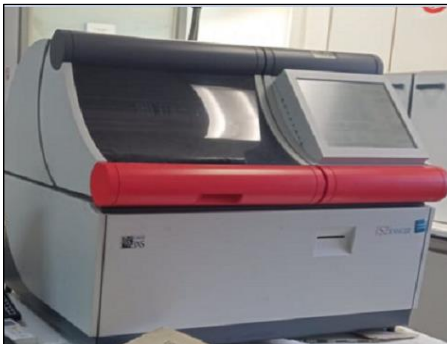
Εικόνα 28. Φασματόμετρο τύπου S2 Ranger (Bruker AXS) του Εργαστηρίου Ανόργανης και Οργανικής Γεωχημείας της Σχολής Μηχ. Ορυκτών Πόρων, όπου πραγματοποιήθηκαν οι χημικές αναλύσεις.
