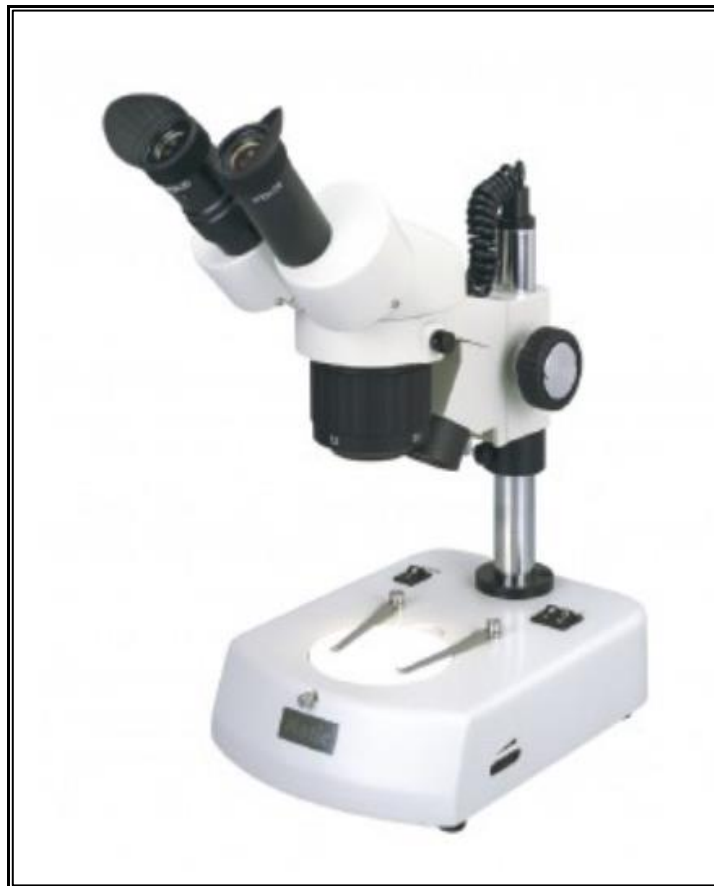
Εικόνα 17. Στερεοσκόπιο SFC-11A N2GG, Motic, του Εργαστηρίου Πετρολογίας και Οικονομικής Γεωλογίας του Πολυτεχνείου Κρήτης.
