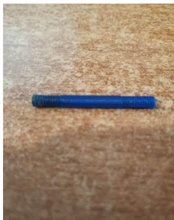
Εικόνα 116: Εκτύπωση τεμαχίου "2-way bolt", εμφανής υπερχειλίση υλικού με αποτέλεσμα ανακρίβειας σπειρώματος
