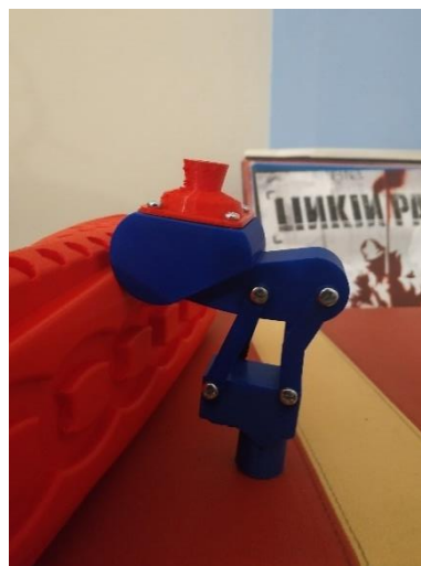
Εικόνα 120: Εκτύπωση και συναρμολόγηση του μηχανισμού του γονάτου
