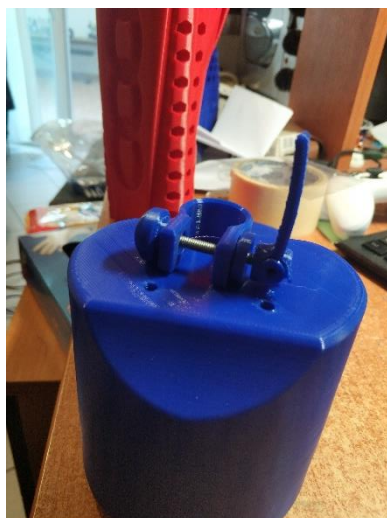
Εικόνα 119: Εκτύπωση και συναρμολόγηση του μηχανισμού "Quick Release Clamp"
