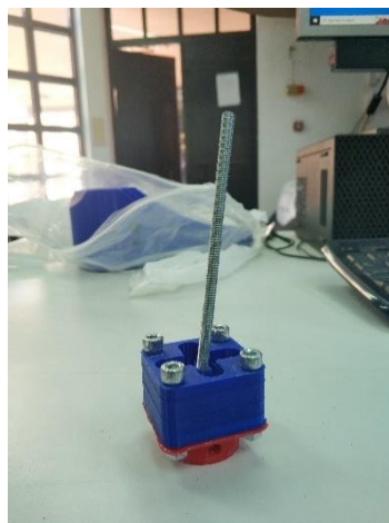
Εικόνα 118: Εκτύπωση και συναρμολόγηση του μηχανισμού του αστραγάλου
