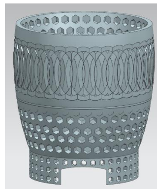
Εικόνα 62: Μορφοποίηση τεμαχίου μέσω Extrude/Revolve
