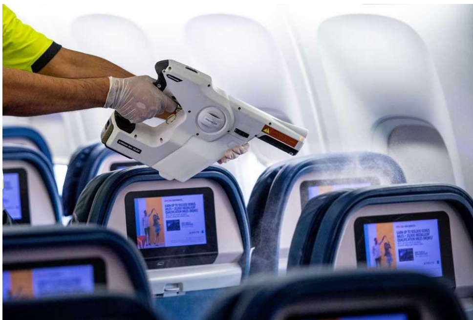
Εικόνα 6: Ειδική συσκευή απολύμανσης των καθισμάτων
