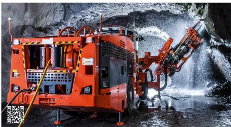
Εικόνα 33 Διατρητικό τύπου Sandvik DL431 (Sandvik 2022)
