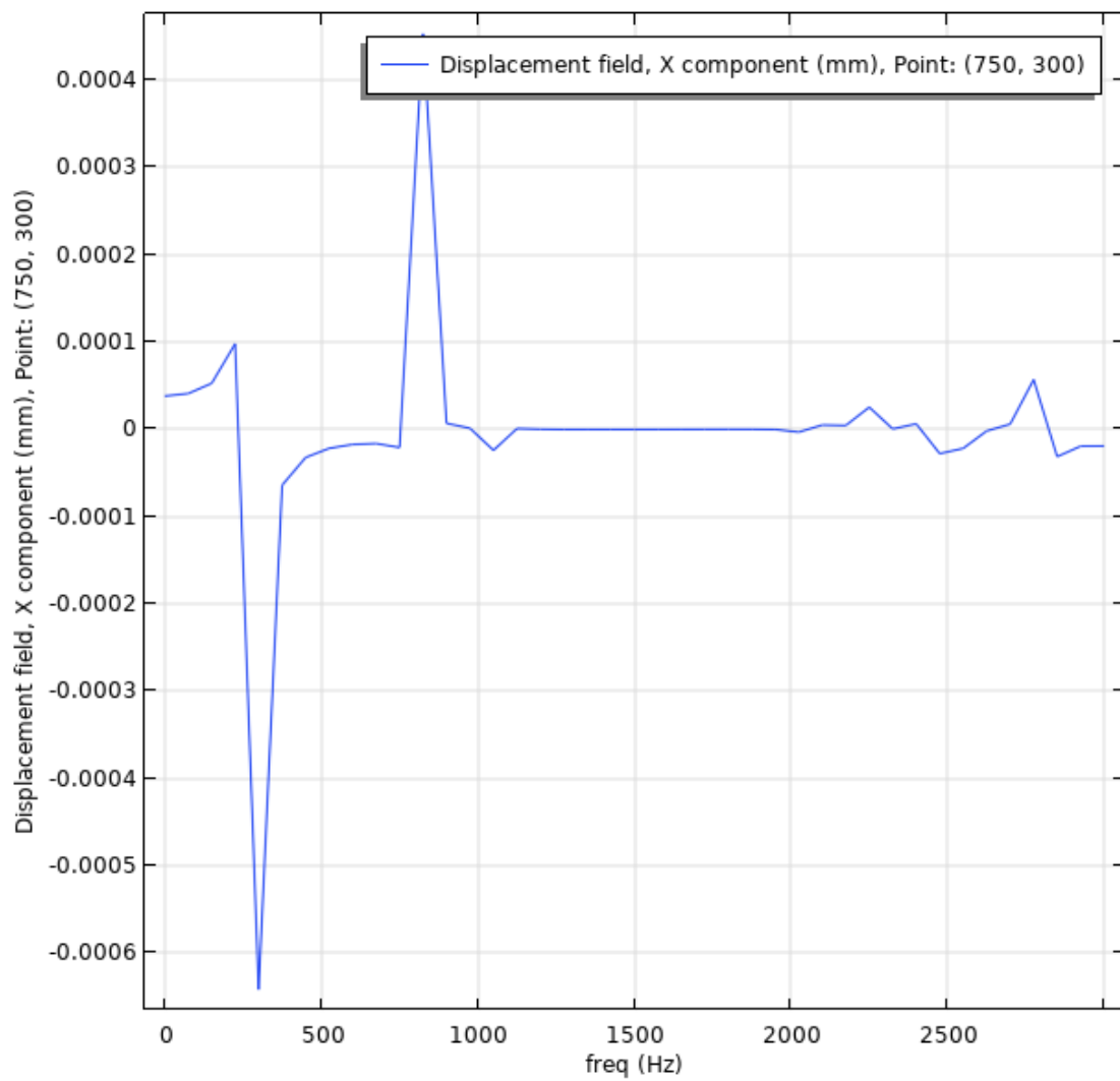
Εικόνα 51 Διάγραμμα μετατόπισης-συχνότητας πλέγματος συνδυασμού ελλείψεων 170X80 με ράβδο 12mm & έλλειψη 170X40, με κυκλικό έγκλεισμα διαμέτρου 40mm και πάχος ράβδου 12mm
