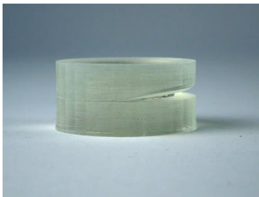
Σχήμα 6.43: Οι διαχωρισμένες στρώσεις είναι μια βλάβη της εκτύπωσης του τρισδιάστατου εκτυπωτή.
