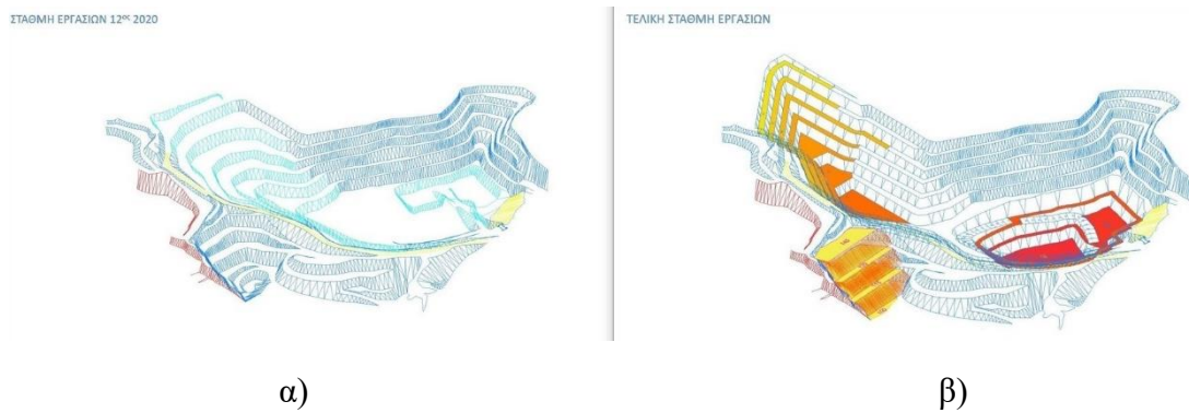
Σχήμα 4.3: Τρισδιάστατης απεικόνιση α) της τρέχουσας εν έτη 2020 και β) τελικής μορφής εκμετάλλευσης (Προσωπικό αρχείο INTERMPIETON ΔΟΜΙΚΑ ΥΛΙΚΑ Α.Ε.)
