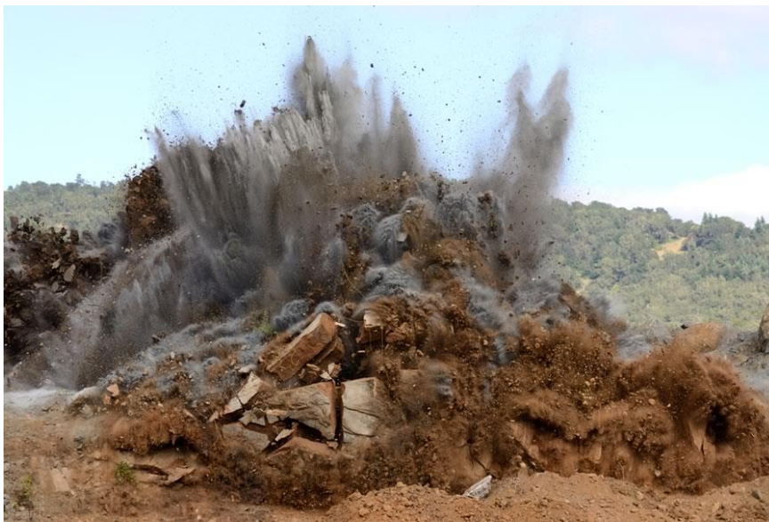
Σχήμα 2.2 Στιγμιότυπο ανατίναξης και θραύσης πετρώματος με τη χρήση εκρηκτικών υλών ( www.stop3009vulcanquarry.com )
