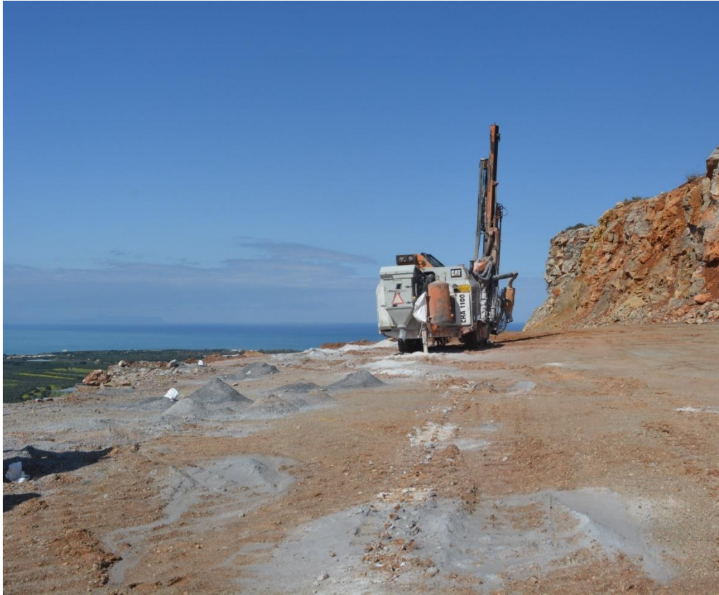
Σχήμα 4.6: Επιτόπια λήψη ερπυστριοφόρου διατρητικού μηχανήματος, στο λατομικό χώρο 3, B17, στο Ανατολικό ορόσημο του λατομείου (Προσωπικό αρχείο Γόγαλη Καλλιόπη)
