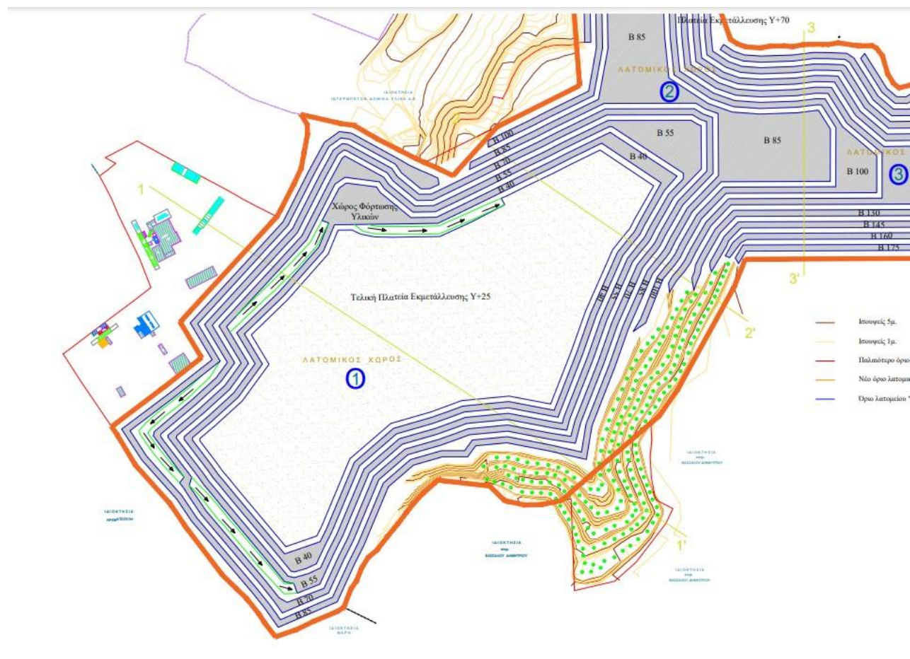
Σχήμα 4.1 Βαθμίδες εκμετάλλευσης του λατομείου στη θέση «Λατζιμάς» (INTERMPETON ΔΟΜΙΚΑ ΥΛΙΚΑ Α. , 2019)
