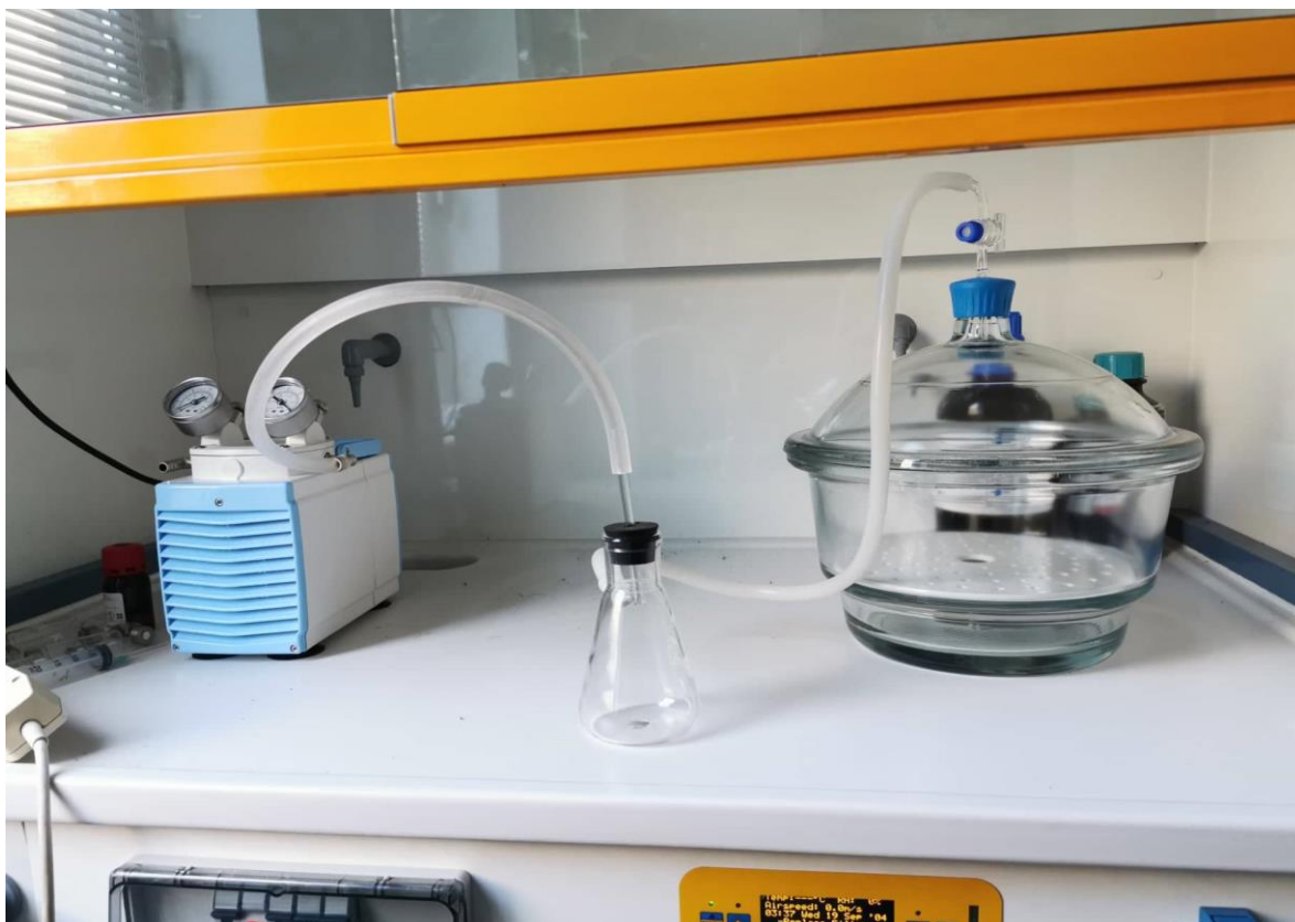
Εικόνα 8: Διάταξη για τον υποκαπνισμό των δειγμάτων
