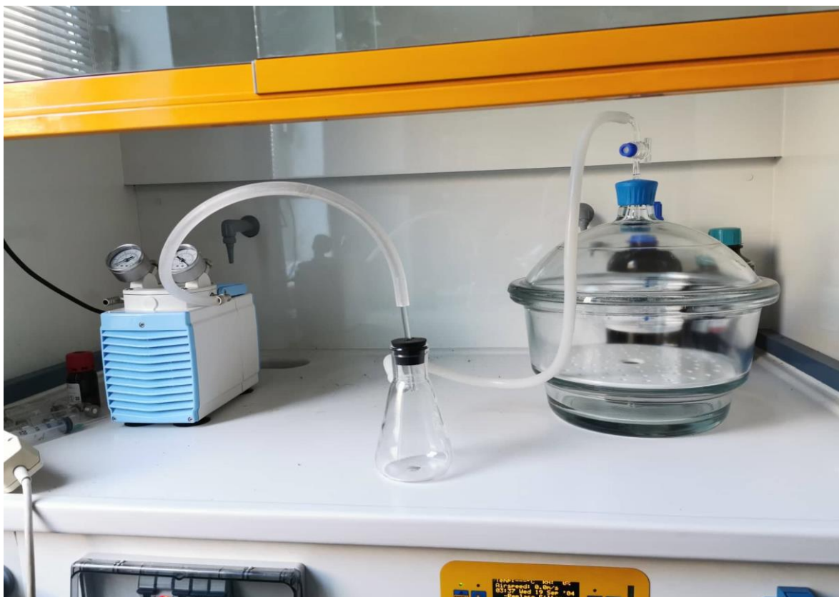
Εικόνα 20: Διάταξη για τον υποκαπνισμό των δειγμάτων
