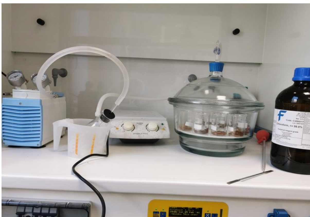
Εικόνα 19 : Πειραματική διάταξη κατά την διάρκεια υποκάπνισης δειγμάτων
