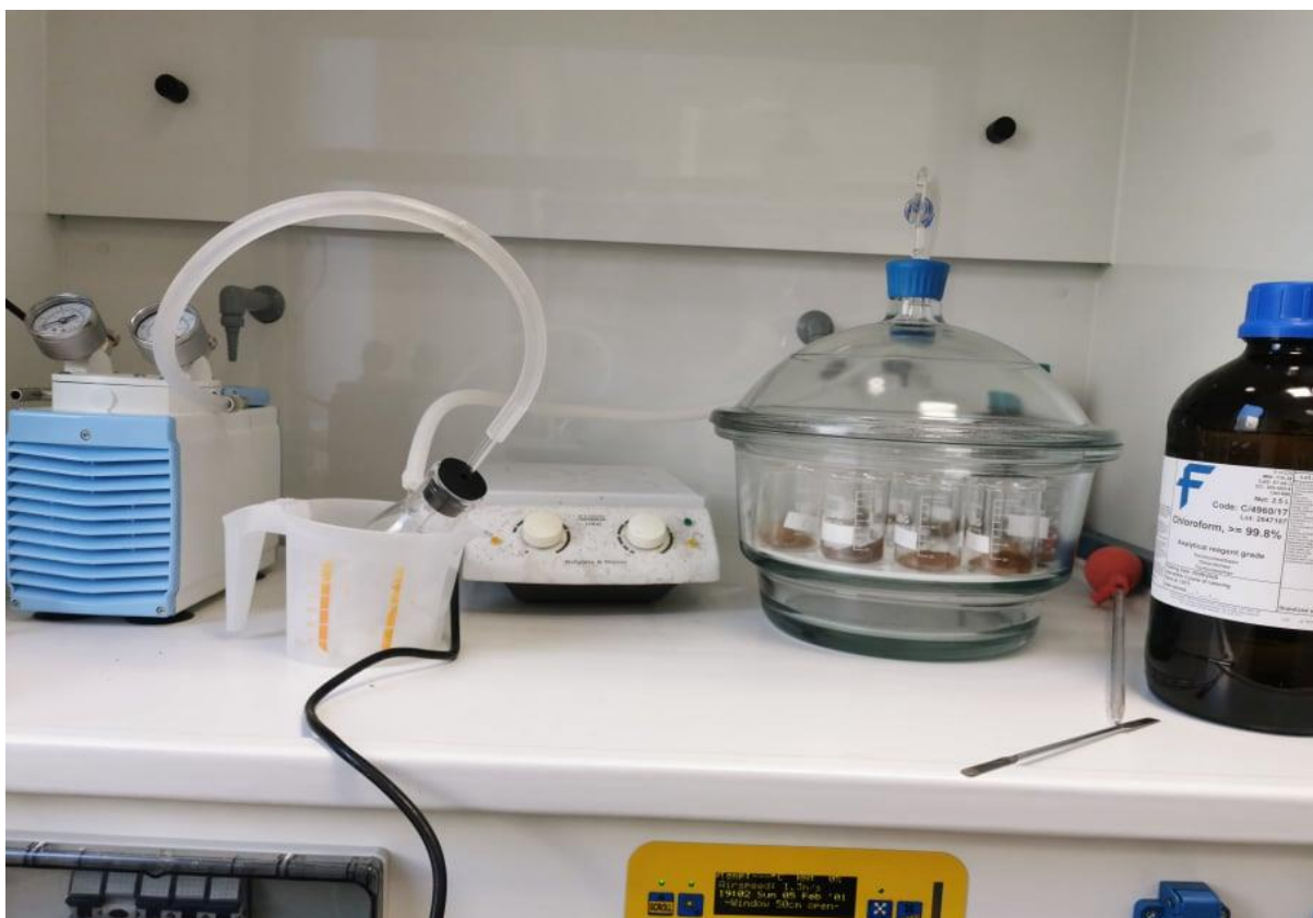
Εικόνα 9 : Πειραματική διάταξη κατά την διάρκεια υποκάπνισης δειγμάτων
