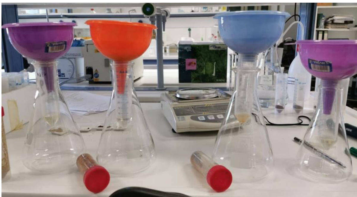
Εικόνα 22: Πειραματική διάταξη για απευθείας εκχύλιση δειγμάτων
