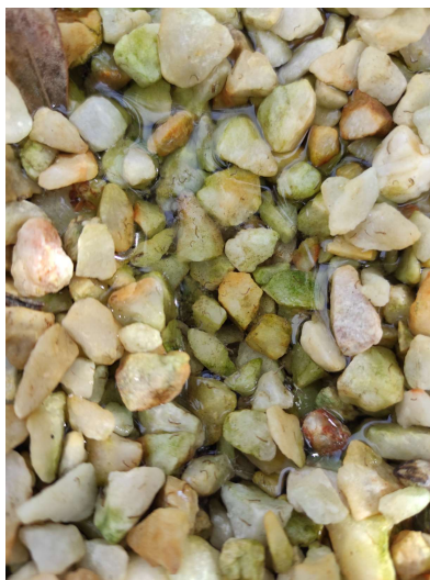
Εικόνα 31. Ανάπτυξη βιοφίλμ στα χαλίκια των πιλοτικών μονάδων
