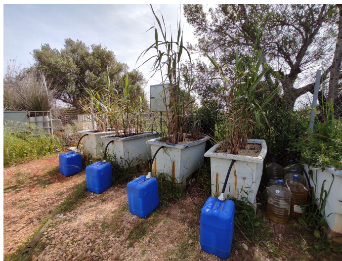
Εικόνα 24. Οι μονάδες τεχνητών υγροβιότοπων στο θερμοκήπιο του Πολυτεχνείου Κρήτης
