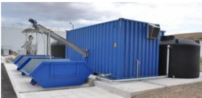
Εικόνα 12 : Τυπική διάταξη compact μονάδας αφυδάτωσης
