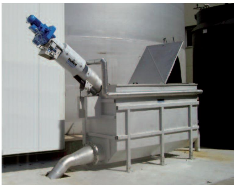
Εικόνα 19 : Τυπική διάταξη compact συστήματος προεπεξεργασίας
