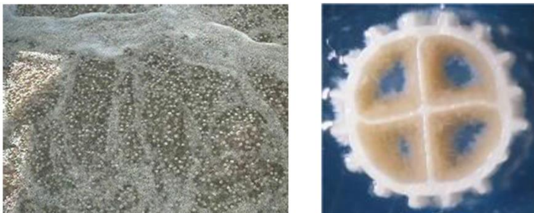
Εικόνα 1 : Πληρωτικό υλικό σε αιώρηση μέσα σε δεξαμενή αερισμού – λεπτομερής άποψη πληρωτικού υλικού
