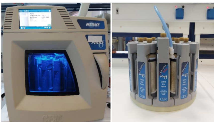
Εικόνα 12: Όργανο χώνευσης με μικροκύματα Mars 6 με τα 12 vessel.
