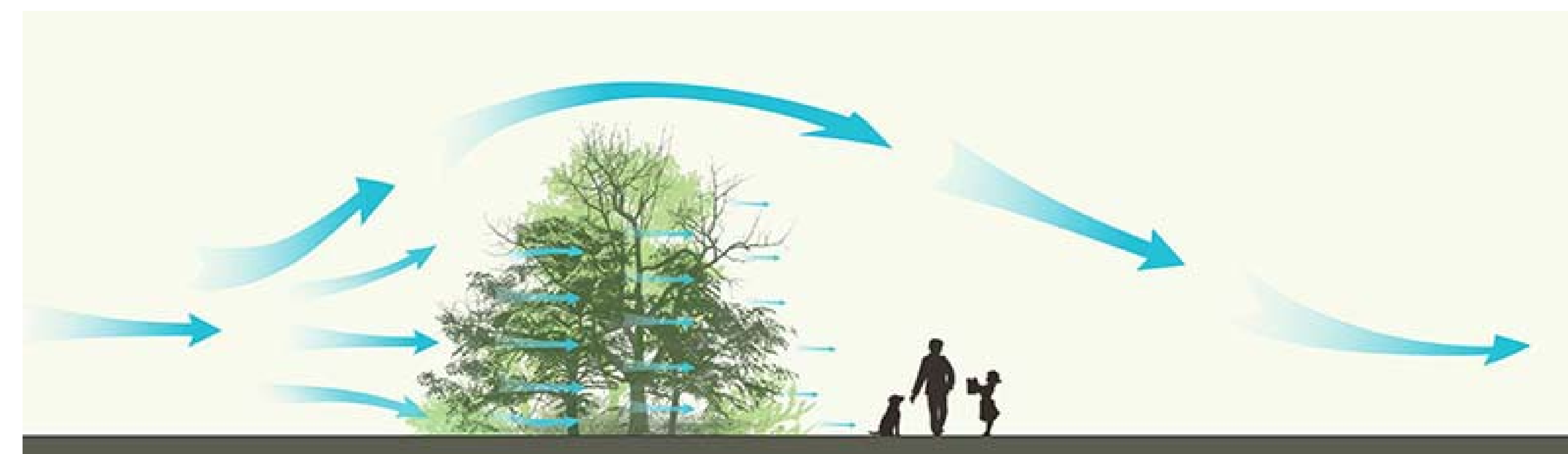
Εικόνα 1B.3: Κίνηση ανέμου γύρω από φυσικό ανεμοφράκτη σε τομή
