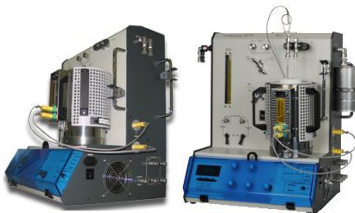
Εικόνα 31: Συσκευή Quantachrome/ChemBet Pulsar TPR/TPD
