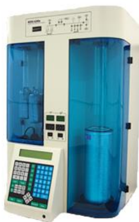
Εικόνα 29: Συσκευή Nova 2200e Quantochrome
